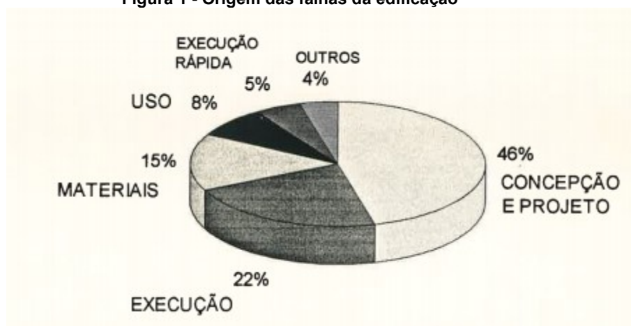
Figura 1 - Origem das falhas da edificação
