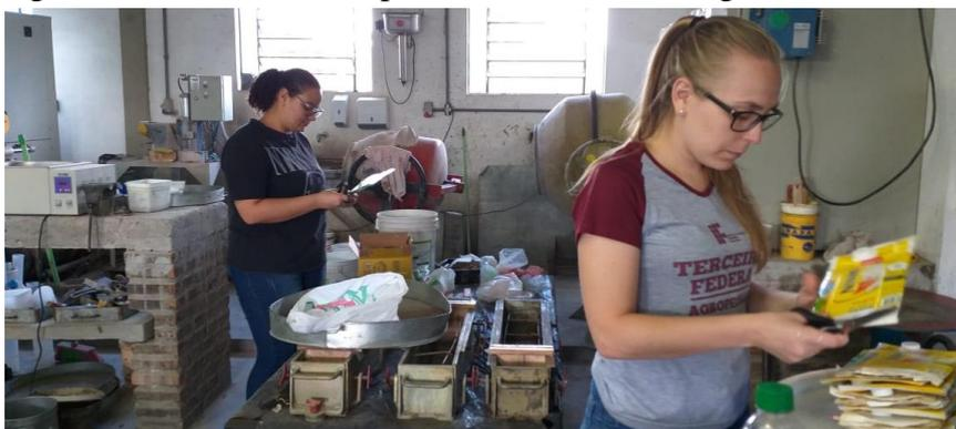
Etapa 2 - A Preparação dos Painéis Térmicos é iniciada após ser atingido uma quantidade significativa de recipiente higienizados, inicia-se a preparação dos painéis (Figura 2). Cada painel é composto por seis caixas da mesma marca unindo-as por grampos, apresentando dimensão final aproximadamente 1m<sup>2</sup>.
