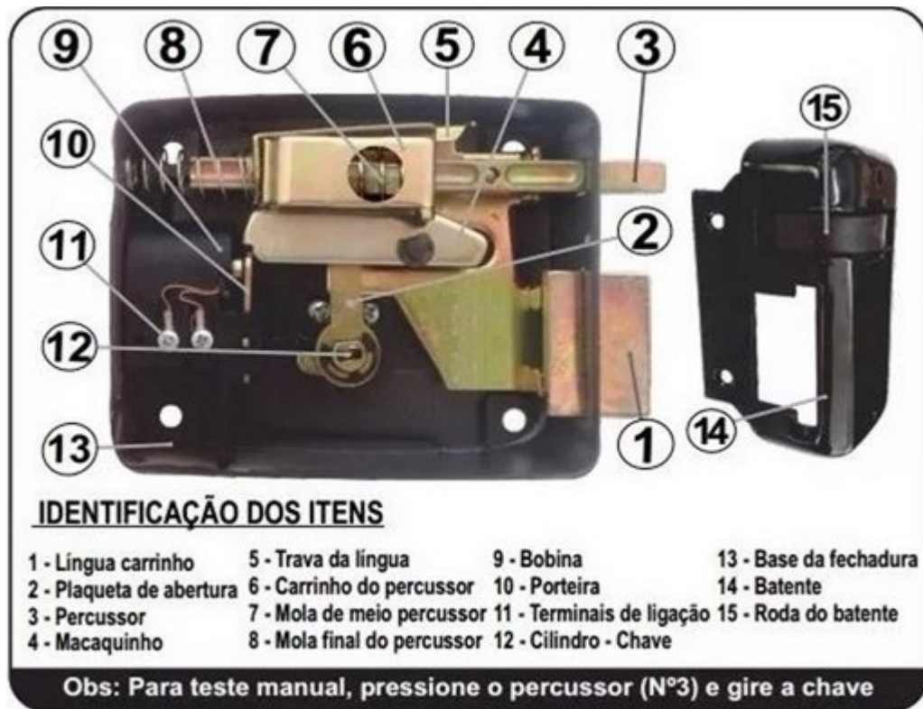
Figura 4 - Composição interna de uma fechadura elétrica
