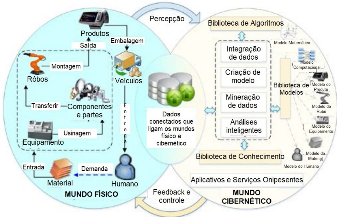
Figura 7 - Modelo de Sistemas de Produção Ciber-Físicos nas Fábricas Inteligentes.
