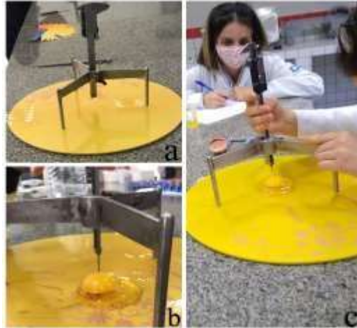
Figura 3- Verificação de alturas de albúmen e gema. Placa de vidro como suporte e paquímetro digital (a); Posicionamento do paquímetro digital rente a gema (b); Aferição de altura (c);
