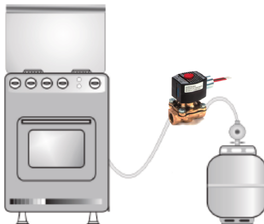
Figura 15 – Linha de fornecimento de gás interceptada por uma válvula solenóide de ação proporcional.
