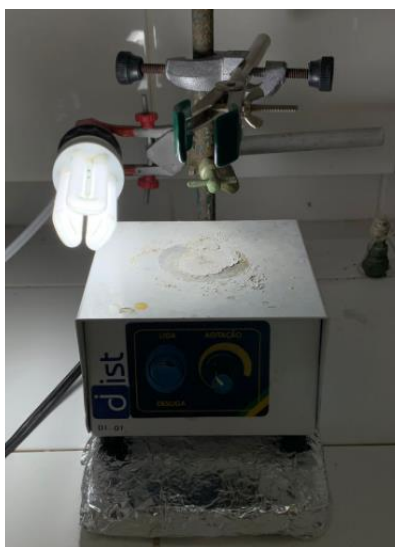
Figura 3. Sistema utilizado para realização da reação fotoquímica.
