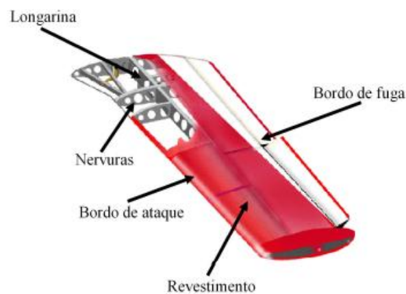
Figura 6 – Elementos estruturais de uma asa de vant
