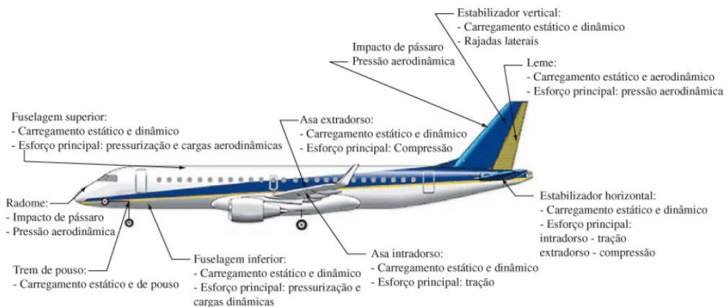
Figura 10 – Principais categorias de cargas atuantes em uma aeronave completa
