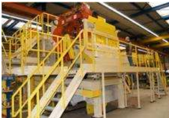
Figura 6.2: a – Eltomatic CVS-16, produção de lã de madeira e b – produção de lã de madeira com máquina de duas facas. Fonte: Eltomation (2006)
