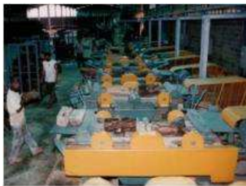
Figura 6.2: a – Eltomatic CVS-16, produção de lã de madeira e b – produção de lã de madeira com máquina de duas facas. Fonte: Eltomation (2006)
