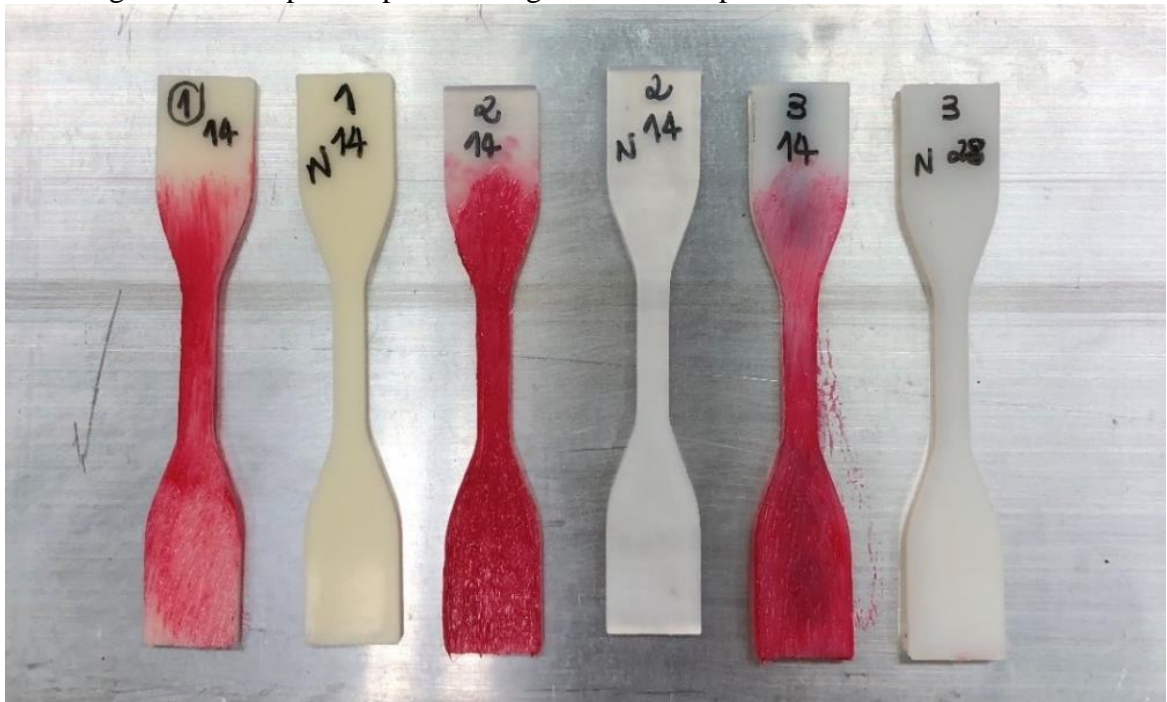
Figura 13 – Corpos-de-prova com graxa antes do processo de envelhecimento.
