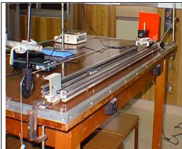
Gráfico 1. Montaje ingenieril para medir fuerzas aplicadas a un cuerpo que se mueve sobre un carril. Simultáneamente se determinan las correspondientes aceleraciones. (Gráfico de diseño propio).
