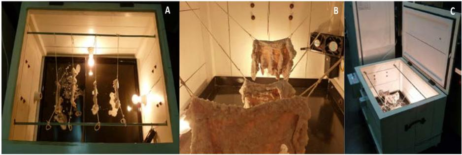
**Figura 3.** Secadero para cuajares bovinos construido de madera estacionada impermeabilizada, con sistema de calefacción generado por bombillas de luz, homogeneización del aire caliente mediante provisión de dos circuladores de aire internos y detector LED externo. A) vista interior superior, B) vista interior frontal, C) vista exterior total.
