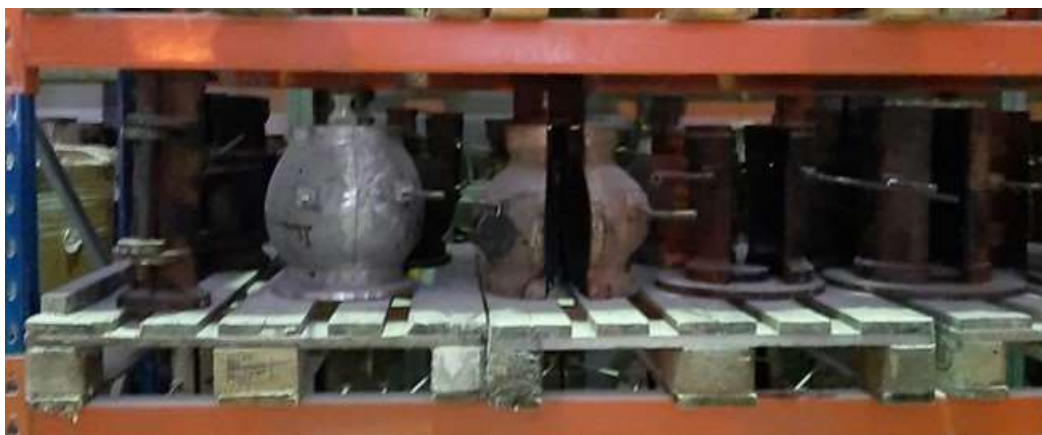
Figura 3: Moldes para vidro que são usados para tirar várias peças. Fonte: própria.
