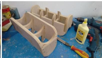
Foi necessário fazer furos laterais com serra copo na estrutura, para ficar com o peso ideal. Na sequência foi realizado o grampeamento de chapas de PVC de 1 e 2mm de espessura na estrutura. As chapas foram reaproveitadas de pranchas de PCCs de ex-alunos de Design da UFSC.
