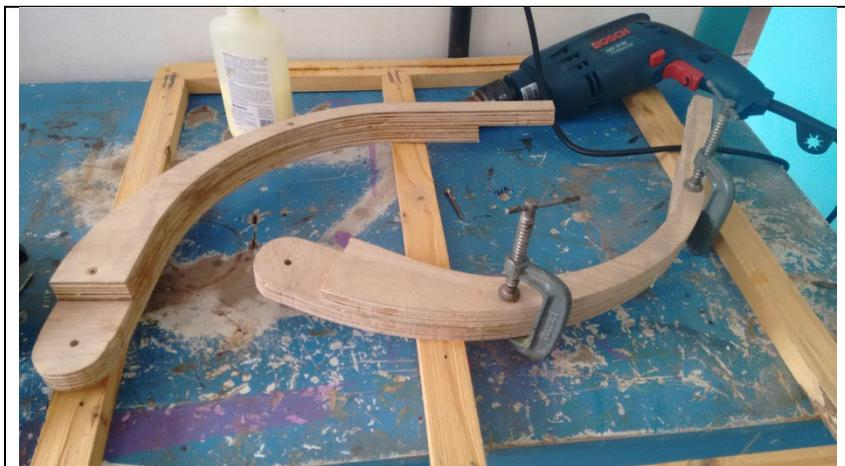
Nesta imagem o arco da estrutura do apoio de tronco está montado recebendo o lixamento para ficar com todos os cantos arredondados, pois na sequência será forrado com espuma e tecido.
