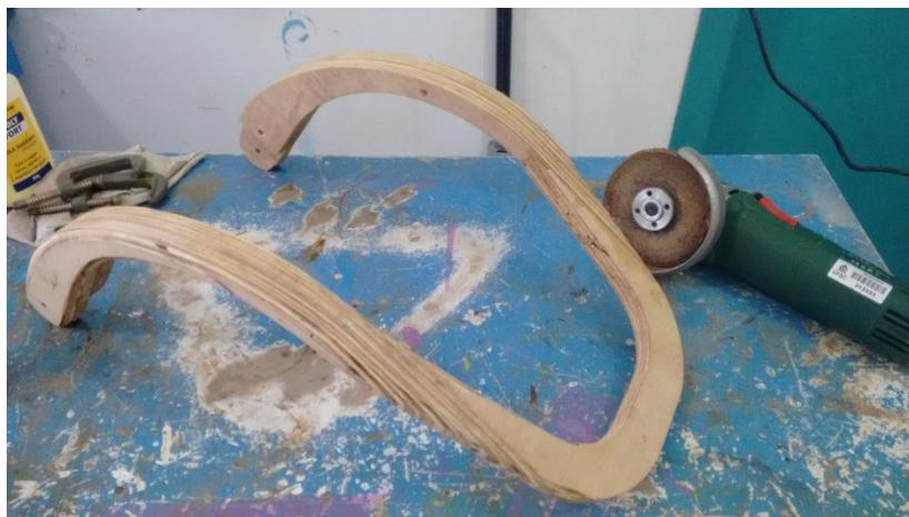
A imagem abaixo mostra como ficou a estrutura pronta para receber a forração com lâmina de espuma 20mm e tecido.
