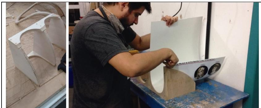
Depois de grampeadas ecortadas as chapas de PVC. Foram lixados todos os cantos vivos para não danificar o forro de espuma de 20mm que viria a seguir.
