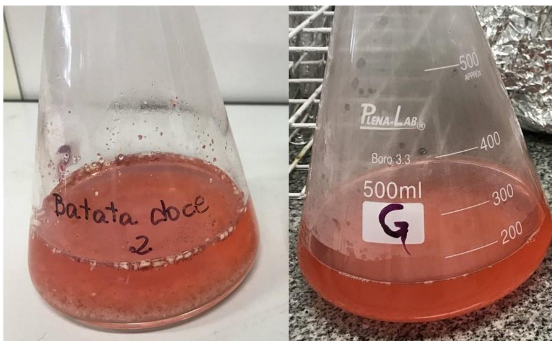
Figura 9 - Extrato de antocianinas antes e após ser filtrado obtido do pó da casca da batata-doce.
