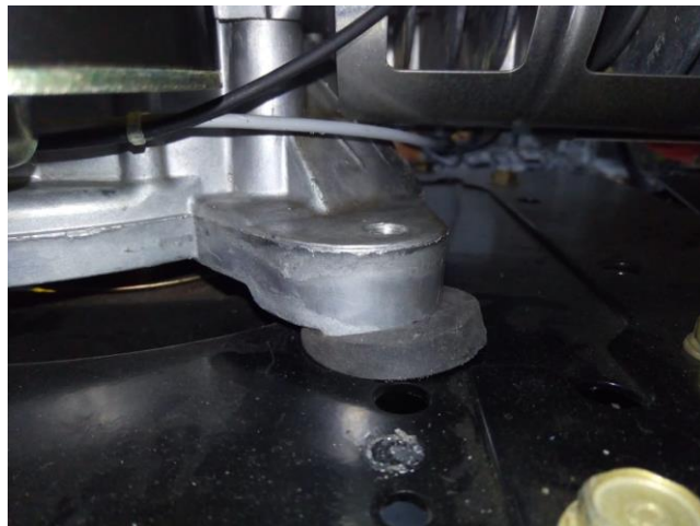
Figura 13 - Coxim adaptado no trator
