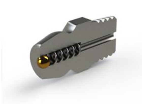
Figura 6 - Vista em corte do bico graxeiro
