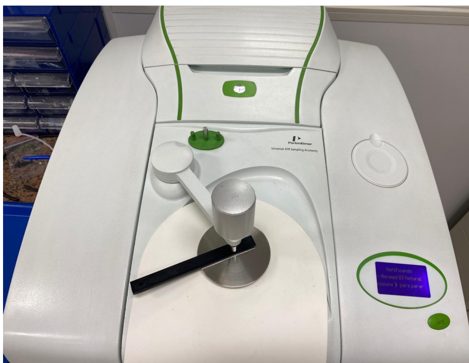
Figura 27 – Amostra de PA6 sendo ensaiada no equipamento de FTIR
