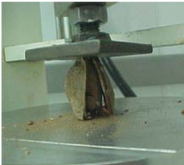
Figura 1. Ilustração de ensaio de compressão, longitudinalmente, em castanha-do-brasil evidenciando a separação dos carpelos.
