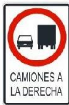
Ilustración 63: Señal de vehículos pesados a la derecha (R-18).
