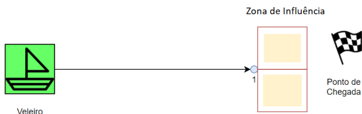
Figura 3.6: Cenário com um mínimo local devido à presença de dois obstáculos muito próximos.
