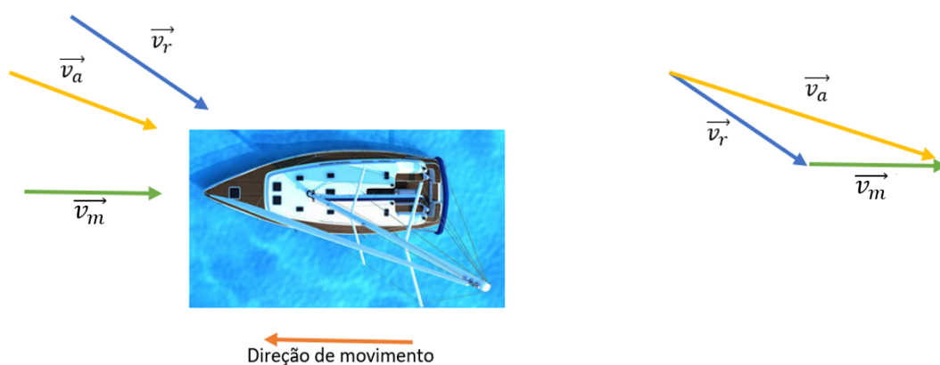
Figura 2.13: Representação vetorial dos diferentes ventos sentidos num veleiro. Imagem Adaptada de: [dreamstime 2021].
