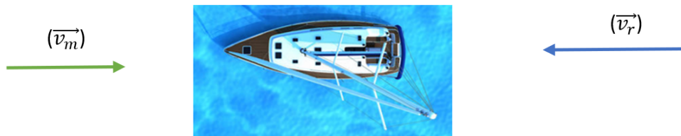
Figura 2.14: Vetores sentidos (força do vento) num veleiro numa situação de mareação à popa arrasada. Imagem Adaptada de: [dreamstime 2021].
