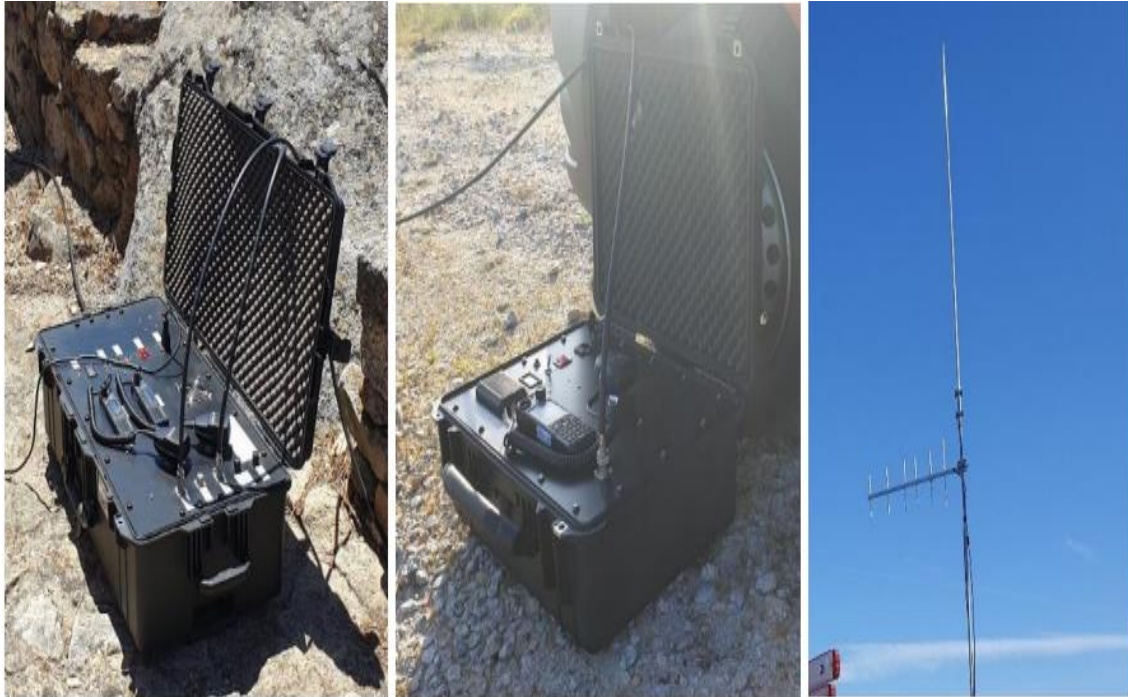
Figura 21 - Sistema de comunicações da banda alta de VHF e terminal TETRA com gateway/ repeater e antenas TETRA omnidirecional e Yagi-Uda (Fonte: CBS Braga)
