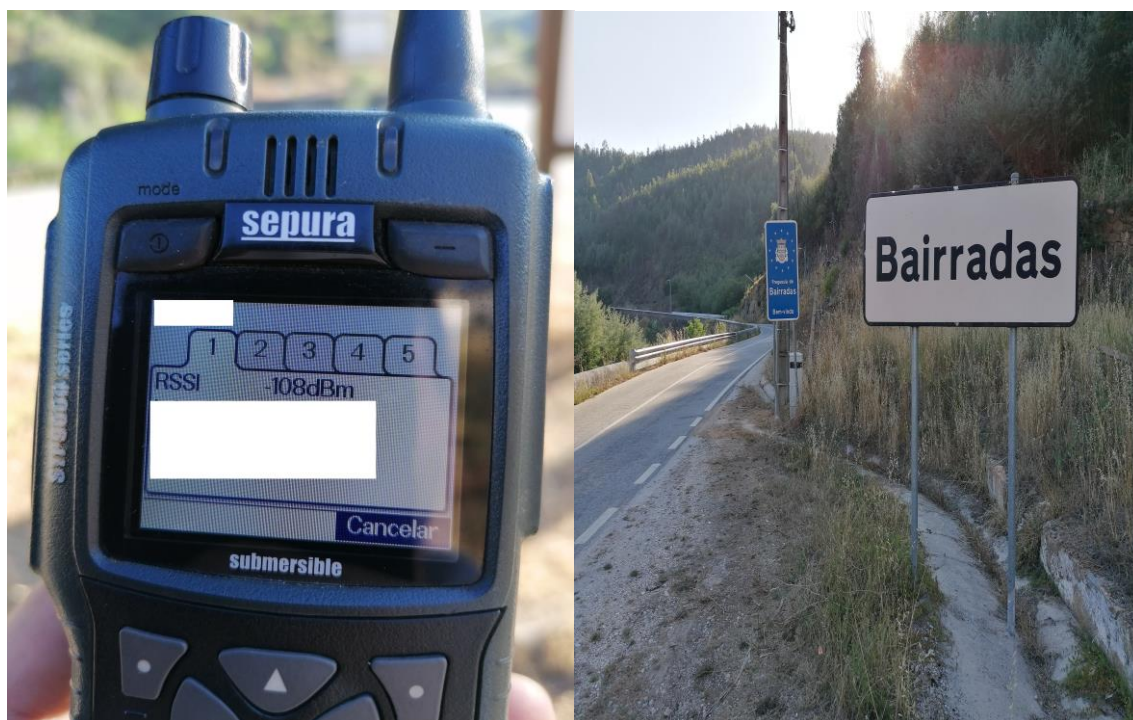
Figura 11 - Medição da intensidade do sinal rádio na União de freguesia de Figueiró dos Vinhos e Bairradas
