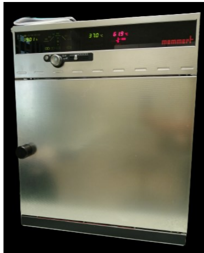
Figura 16- Estufa de incubação (Mettmert INE 400) à temperatura de 37 °C
