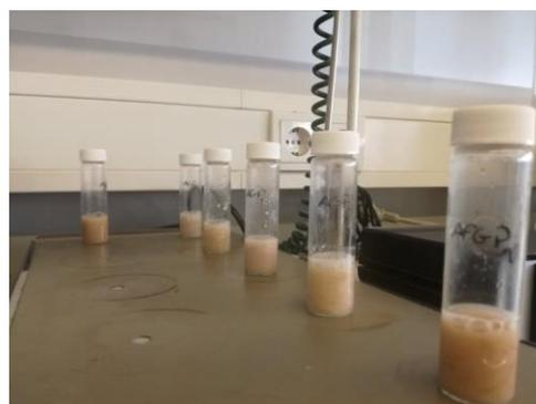
Figura 2-Agitação amostras no multi-rotator
