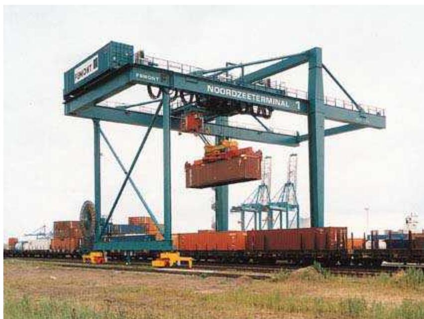
Fig. 1-1 コンテナ輸送用ガントリークレーン([1]より)
