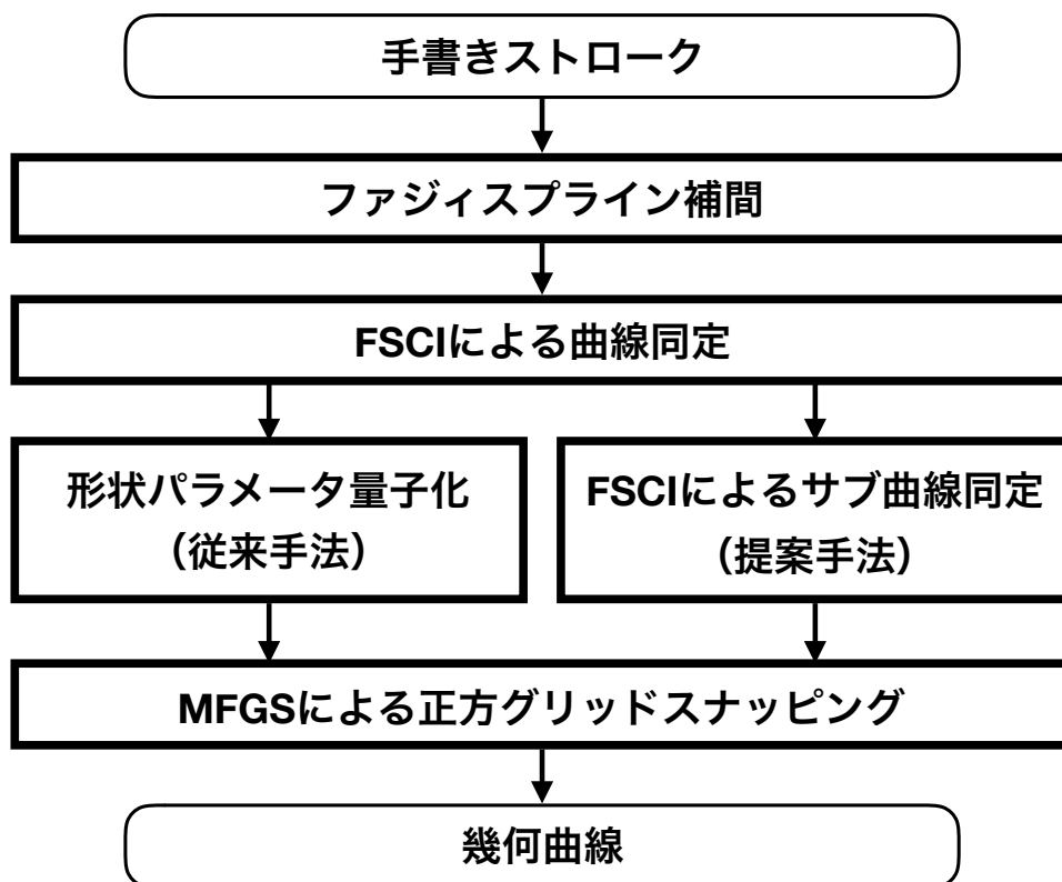
図 3.2: 手書き CAD インターフェースにおける曲線同定の流れ
