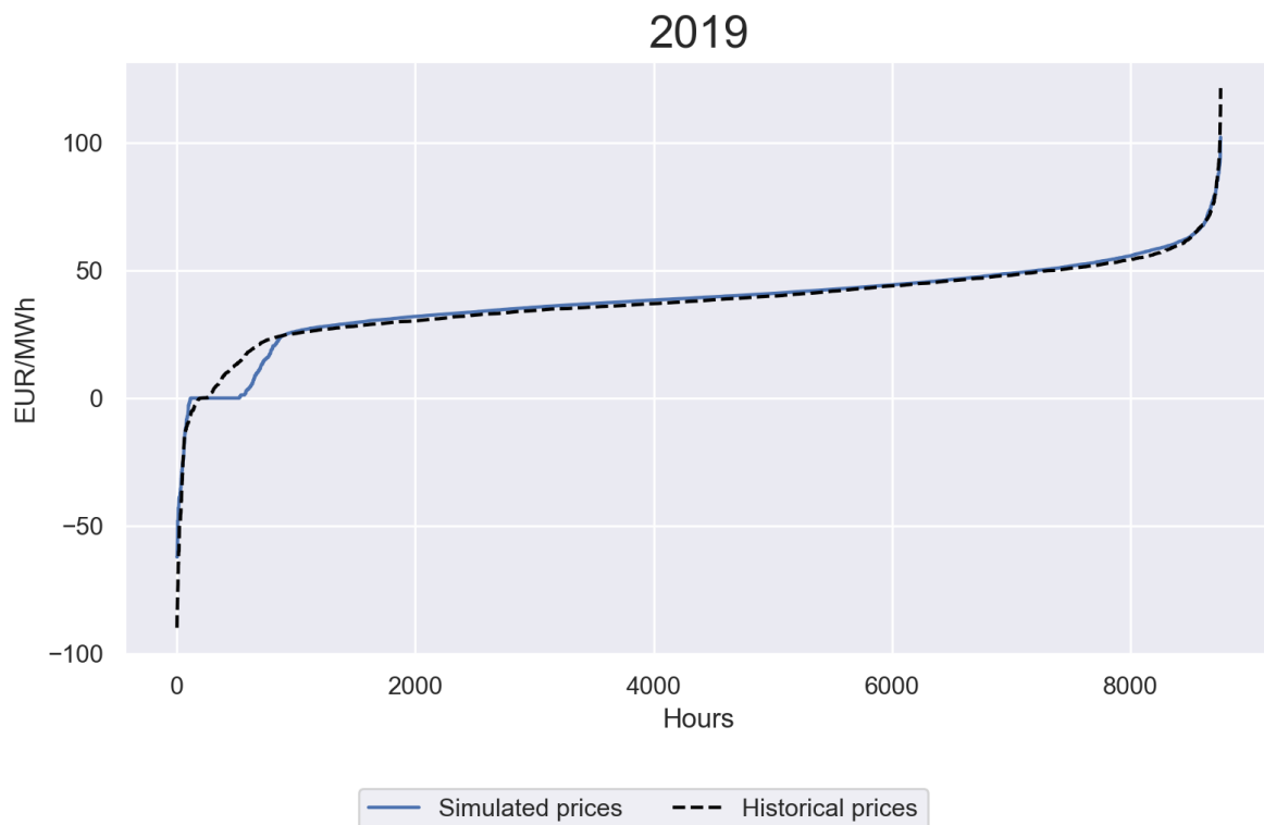
Abbildung 3: Simulierte und reale Preisdauerlinie im Basisfall ohne Lastmanagement
