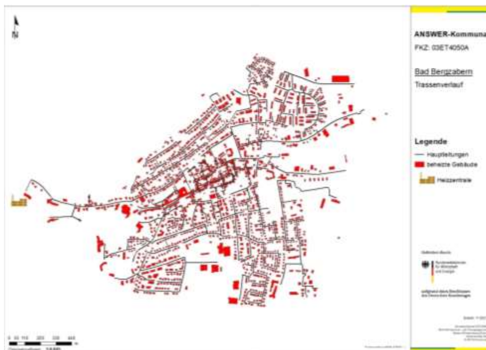
Abbildung 191: Mit GIS-Methoden berechnete Netztrassen und beheizte Gebäude in der Stadt Bad Bergzabern.
