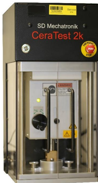
Abbildung 2: Dauerlastprüfmaschine: CeraTest 2k
