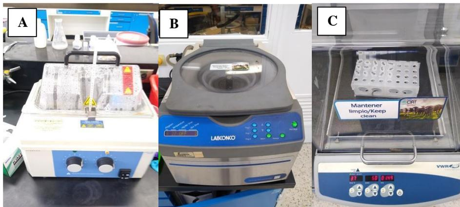
**Imagen No.1** Equipos utilizados durante el proceso de extracción y purificación de ADN donde: **A)** Baño María; **B)** SpeedVac; **C)** Incubadora. Tomado por Malatesta, C. (2022)
