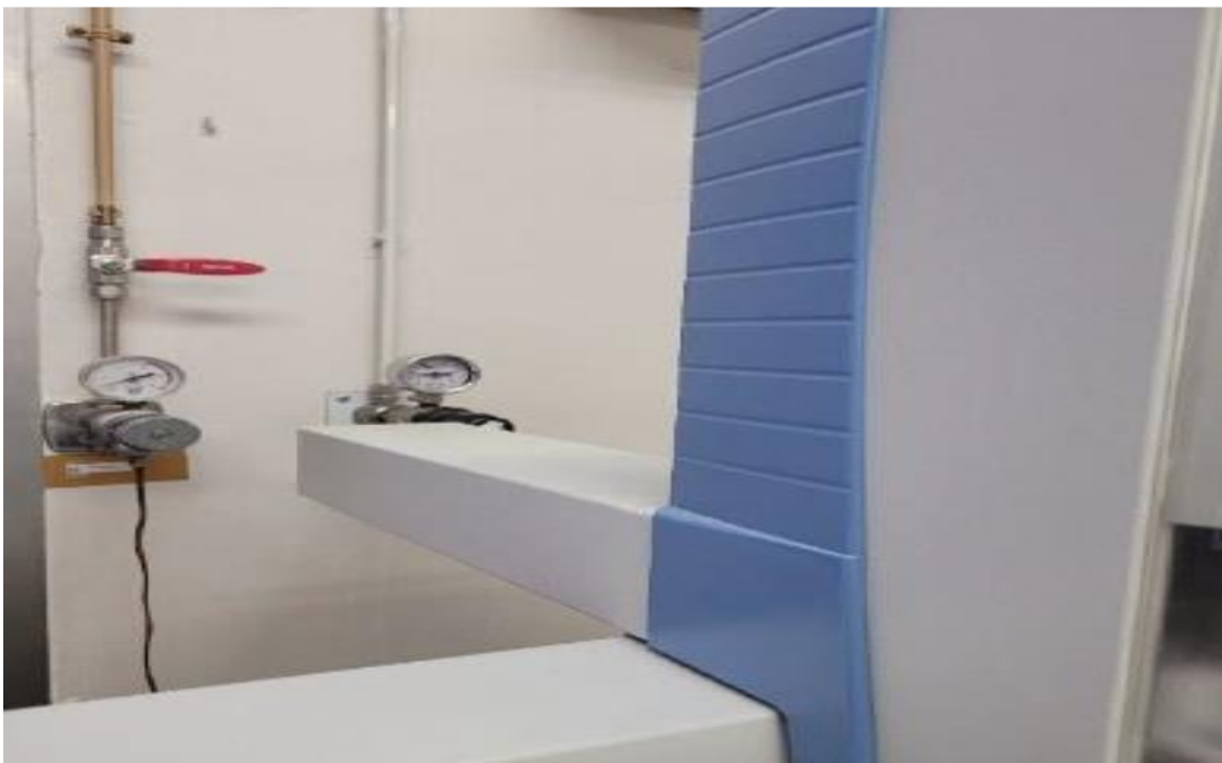
Figura 11. Font de gas amb manòmetre per regular la quantitat d'heli: imatge extreta del laboratori de química (EPSEM).
