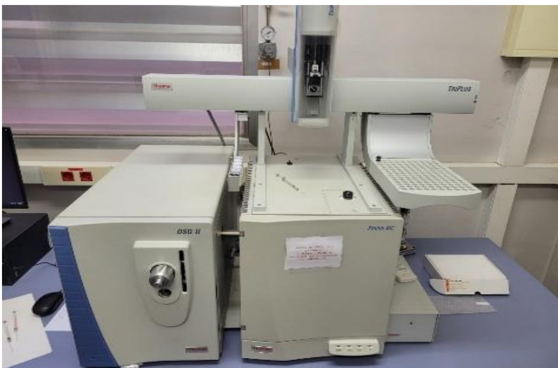
Figura 7. Espectrometre de masses acoblat al cromatografia de gasos: imatge extreta del laboratori de química (EPSEM).
