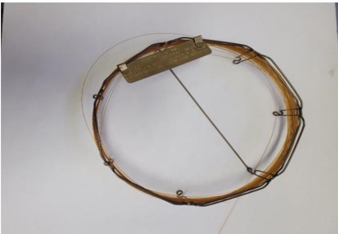
Figura 6. Columna capil·lar: imatge extreta del laboratori de química (EPSEM).
