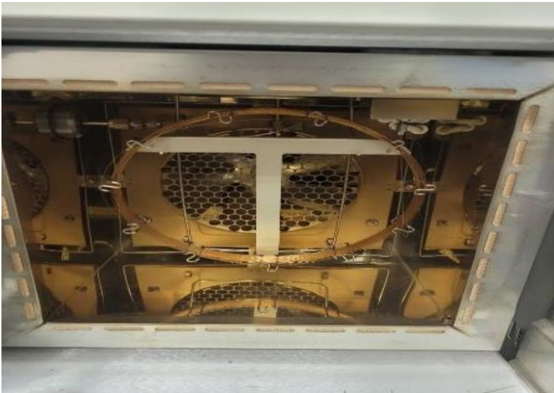
Figura 12. Interior del cromatografia de gas: imatge extreta del laboratori de química (EPSEM).
