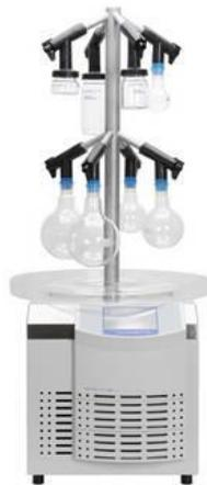
Abbildung 2: Gefriertrockner im Labormaßstab zur Kolbentrocknung [54].
