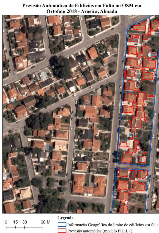
Figura 4.15 - Previsão automática do modelo Full+ numa zona com informação em falta no OSM
