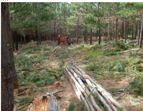
Foto 9. Extracción de varas con tractor y malacate
