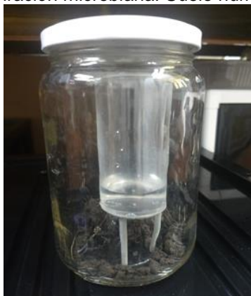
Imagen 12. Ensayo de respiración microbiana. Suelo húmedo en presencia de NaOH.
