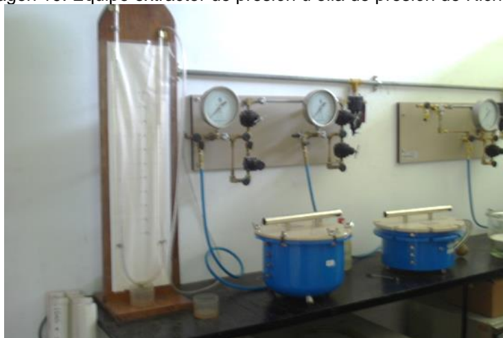
Imagen 19. Equipo extractor de presión u olla de presión de Richards
