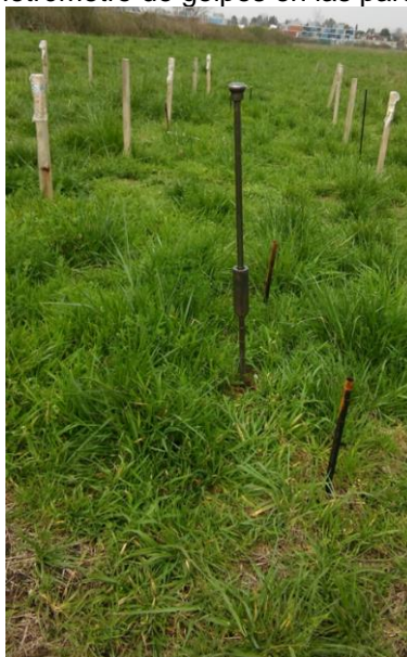
Imagen 20. Penetrómetro de golpes en las parcelas del ensayo
