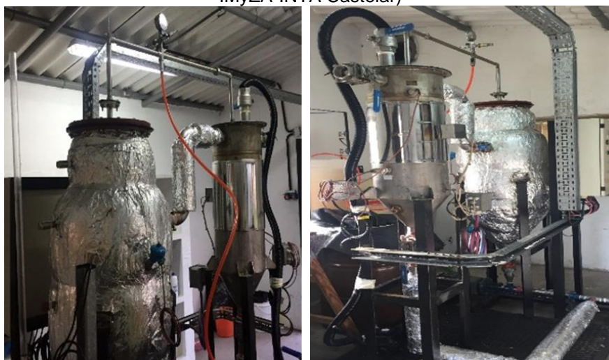
Imagen 6. Reactor anaeróbico alimentado con efluente porcino (Laboratorio Transformación de Residuos-IMyZA-INTA Castelar)
