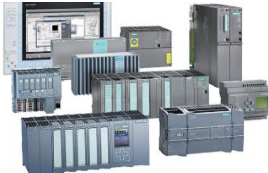
Figura 3.10 Controlador lógico programable [26]
