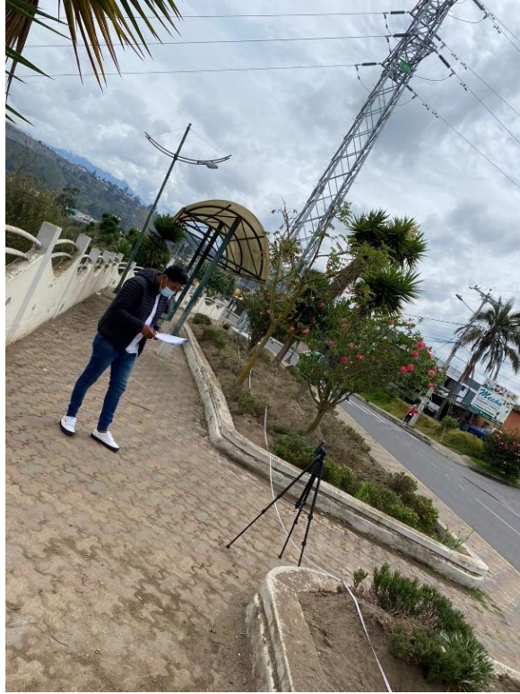
Figura D.7. Toma de datos perfil lateral lado derecho Torre E-1075.
