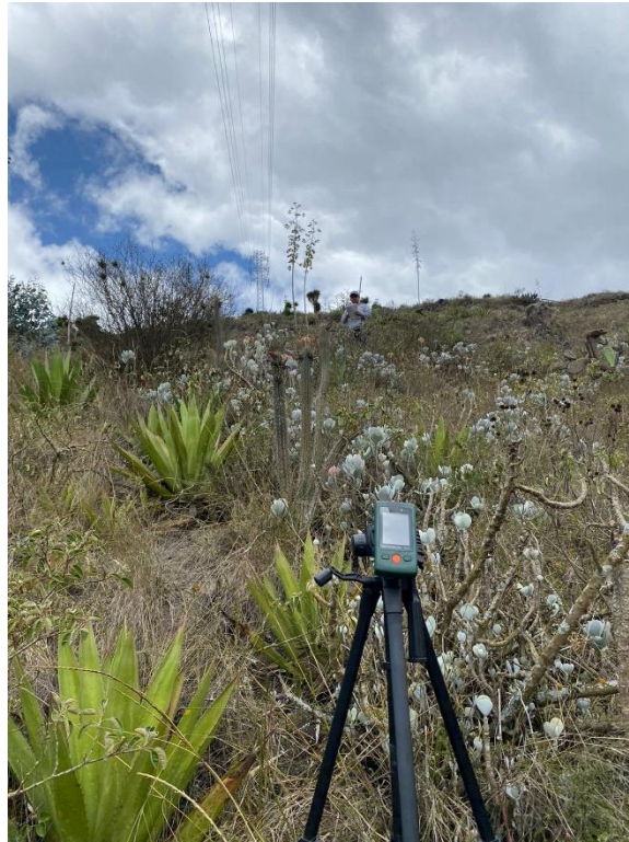
Figura D.5. Apantallamiento del equipo por flora vano atrás Torre E-1075.
