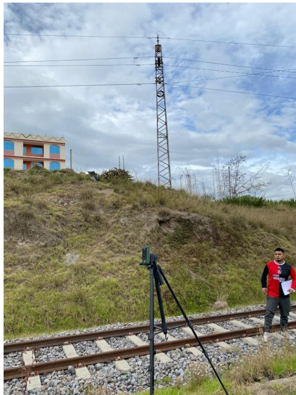
Figura D.16. Toma de datos perfil lateral lado izquierdo Torre E-0268.
