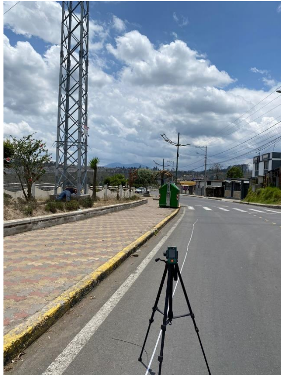
Figura D.8. Toma de datos perfil lateral lado izquierdo Torre E-1075.
