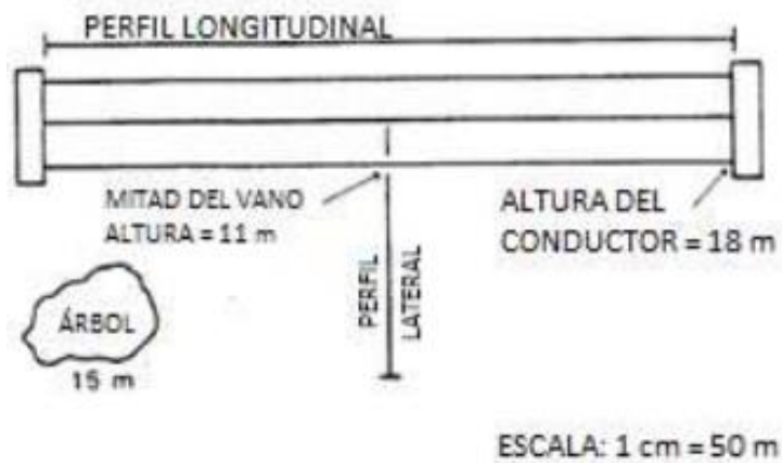
Figura 4.9. Medición perfil longitudinal y lateral [13].
