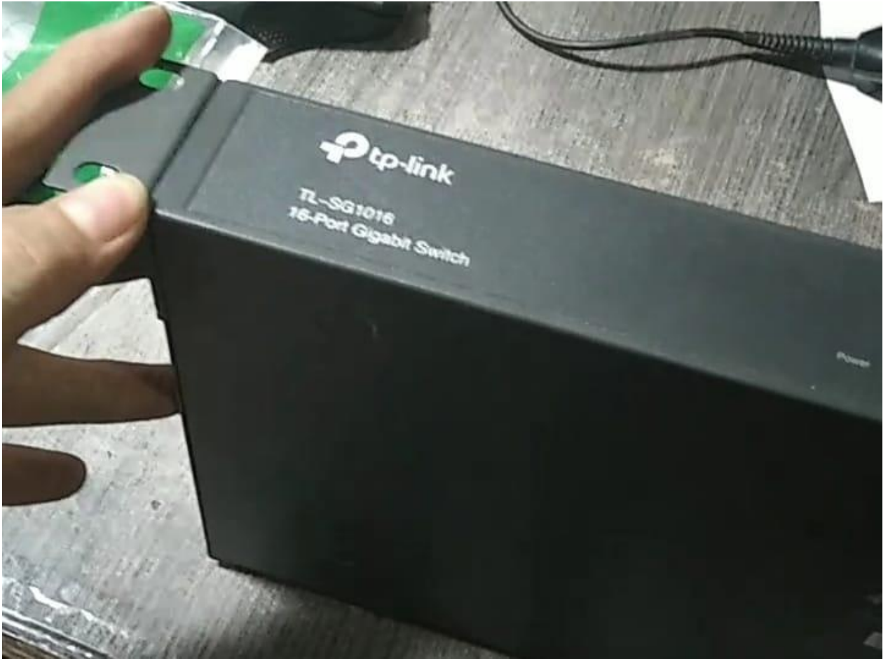
Figura 10.9 Switch de 16 puertos TP Link.
