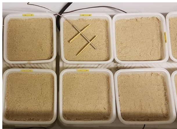
Bilde 2. Frysetesting i plastkasser (Trond Olav Pettersen, NIBIO Landvik).
