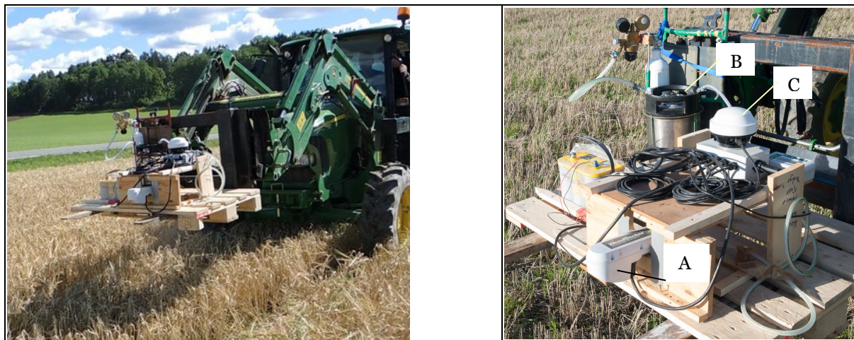
Figur 2.4. Testingen av WeedSeeker i åker ble gjennomført med en selvkonstruert sprøyterigg påmontert traktorens frontlaster. Field tests of WeedSeeker for automatic patch spraying of glyphosate were conducted with a custom-made platform.
