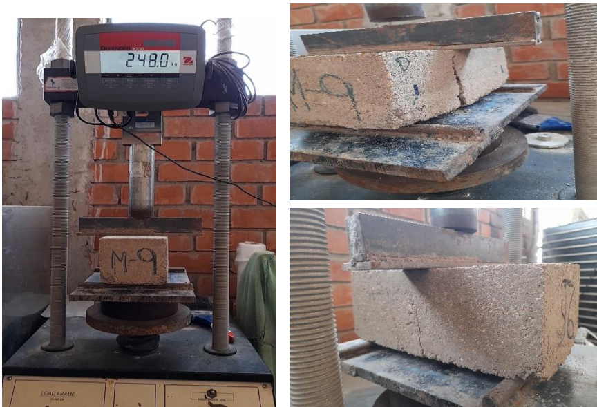
Ensayo de Módulo de Rotura de los Ladrillos Ecológicos de Aserrín
