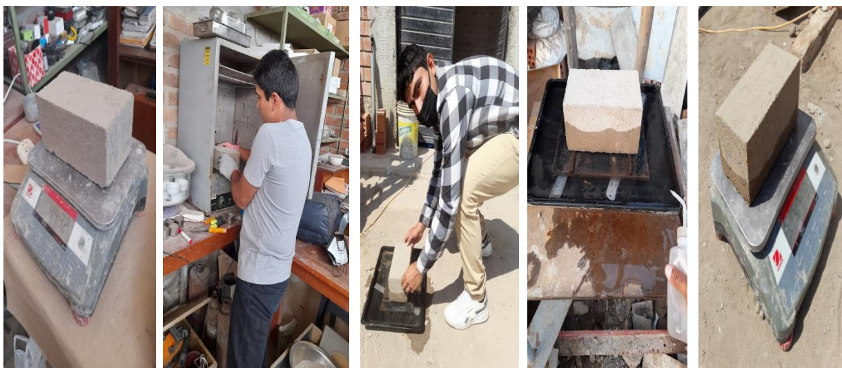
Ensayo de Succión de los Ladrillos Ecológicos de Aserrín
