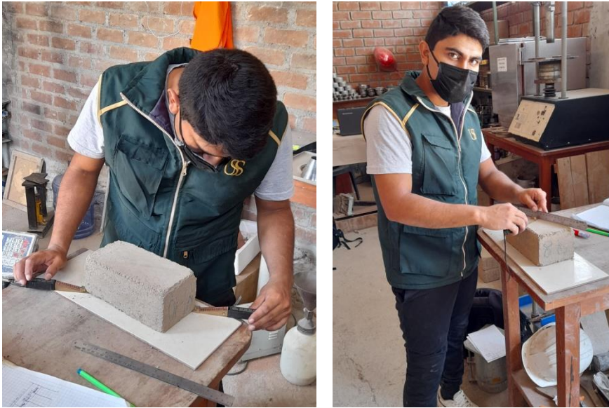
Ensayo de Alabeo de los Ladrillos Ecológicos de Aserrín
