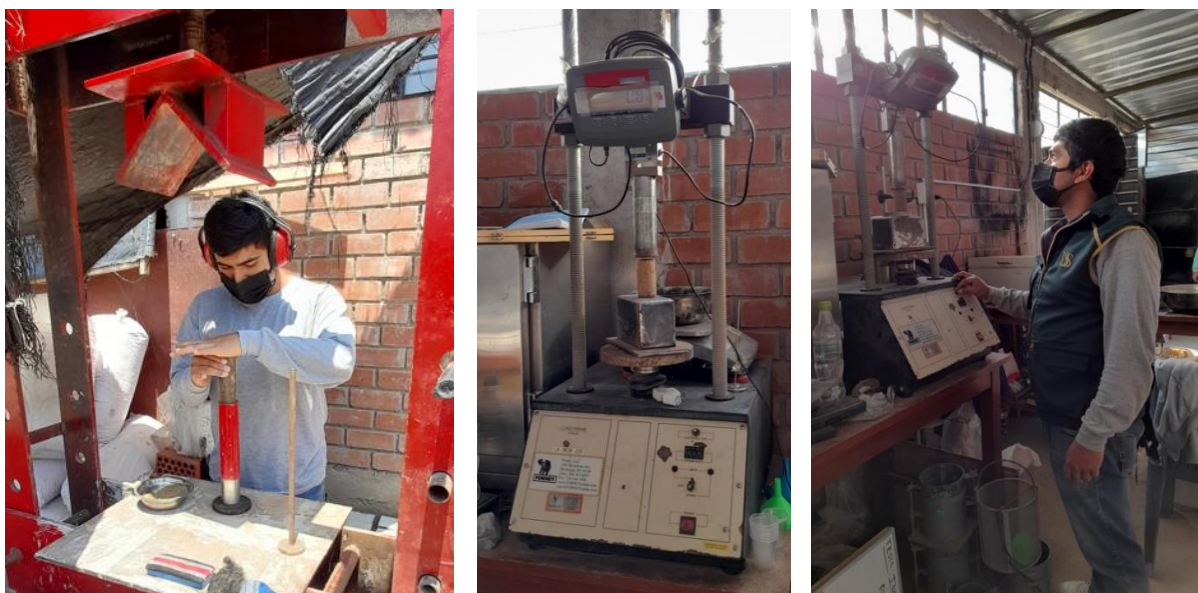
Ensayo Para la Resistencia a la Compresión no Confinada del Suelo Cohesivo
