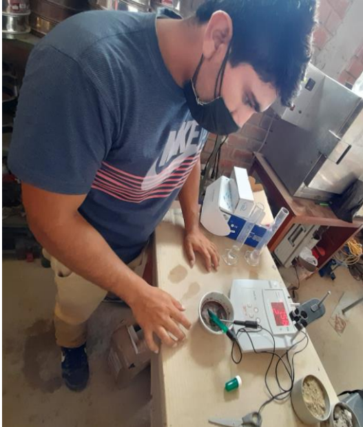
Ensayo del pH del Aserrín
