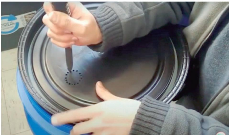
Figura 50. Perforación de la tapa del cilindro
