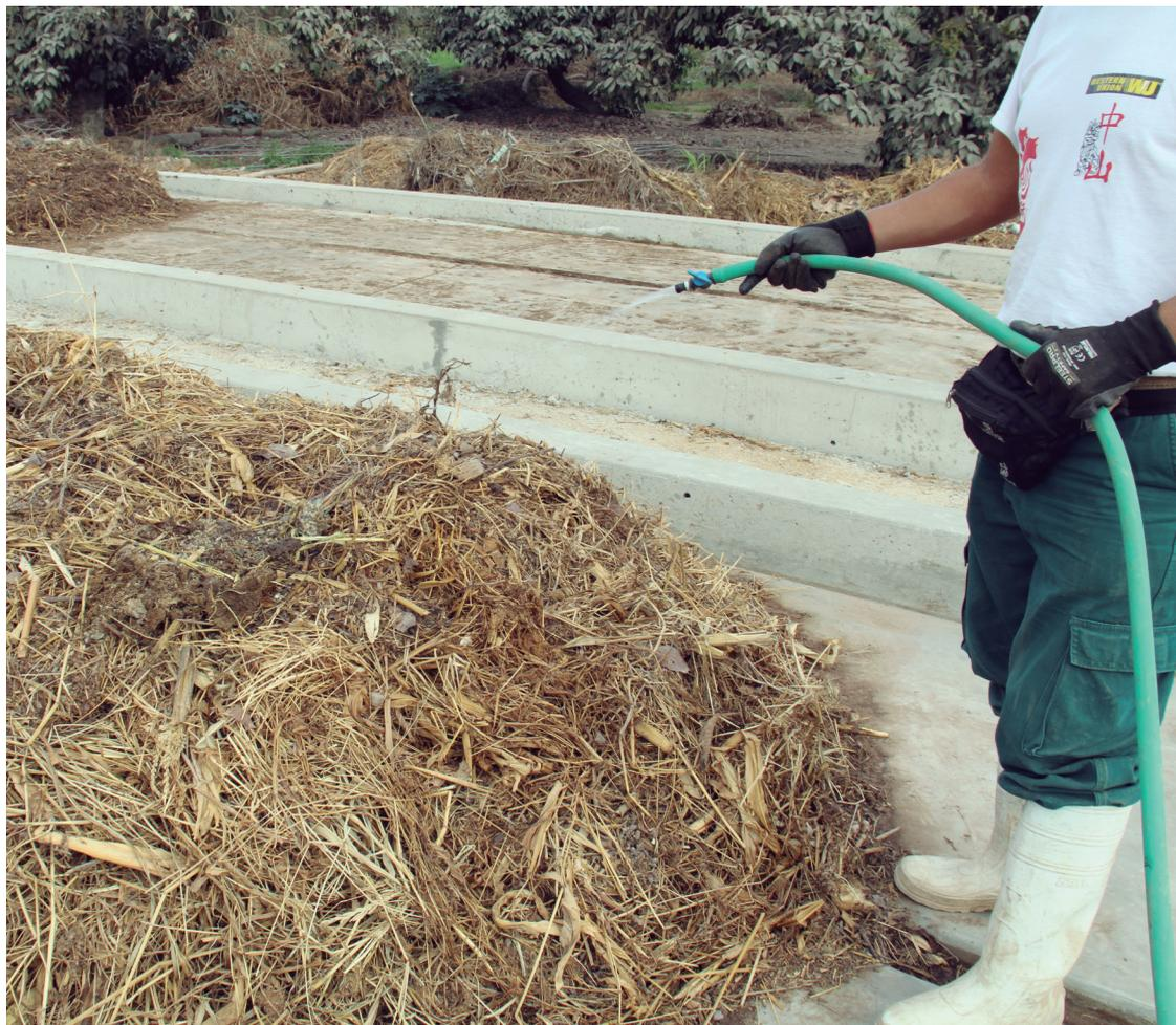
**Figura 21.** Riego de la pila en el proceso de compostaje
