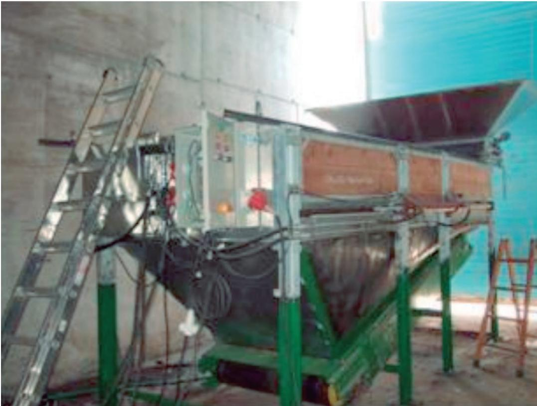
**Figura 57.** Vermirreactor de alimentación semicontinua y descarga vertical
