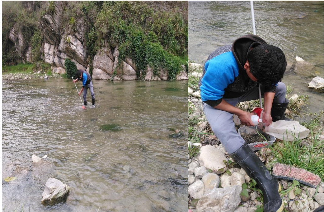
Figura 5. Recolección de muestras de macroinvertebrados en el río Chotano utilizando la red D-net.
