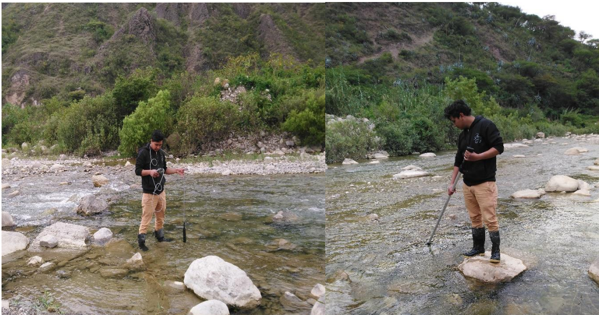
Figura 6. Toma de datos de parámetros fisicoquímicos utilizando el equipo multiparámetro y medición de la velocidad de la corriente del río utilizando un correntómetro.
