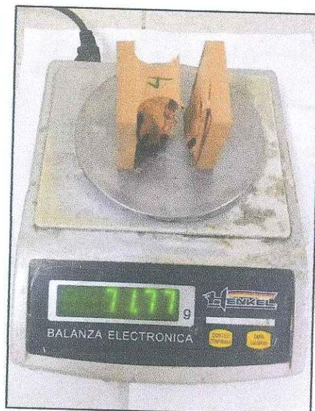
**FIGURA N°28:** Peso de la Probeta 4 después del secado en la estufa.
