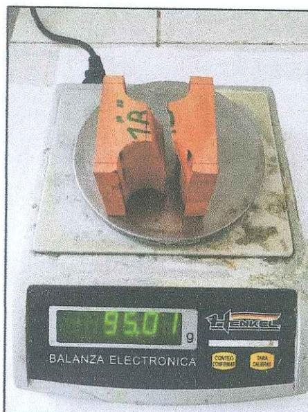
**FIGURA N°21:** Peso de la Probeta 1B antes del secado en la estufa.
