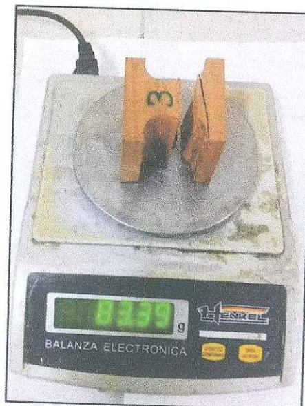
**FIGURA N°26:** Peso de la Probeta 3 después del secado en la estufa.
