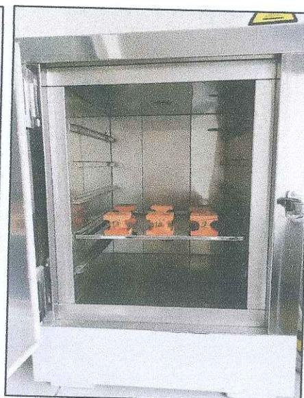
**FIGURA N°31:** Probetas puestas en la Estufa a 103°C durante 3 horas como indica la norma.
