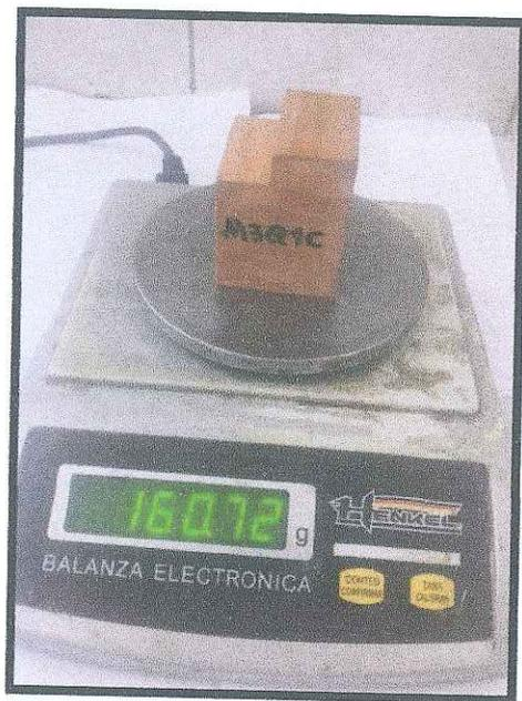
*Figura N°9: peso de la probeta M3Q1c*
