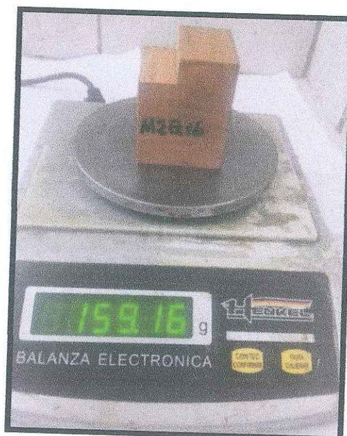
*Figura N°8: peso de la probeta M2Q1b*
