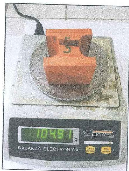
**FIGURA N°29:** Peso de la Probeta 5 antes del secado en la estufa.
