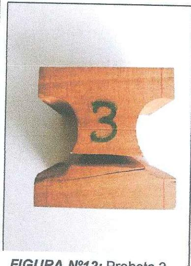
**FIGURA N°12:** Probeta 3 después del ensayo.
