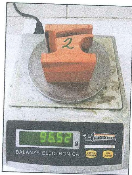
**FIGURA N°23:** Peso de la Probeta 2 antes del secado en la estufa.
