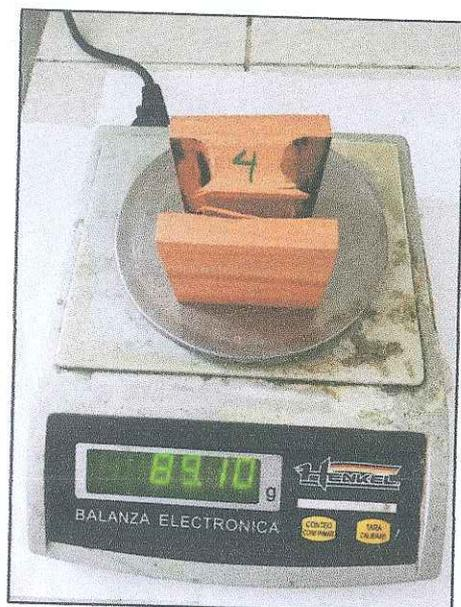
**FIGURA N°27:** Peso de la Probeta 4 antes del secado en la estufa.
