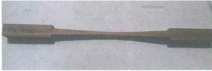
**Figura.Nº10:** Probeta M3Q1c antes de ser ensayada.
