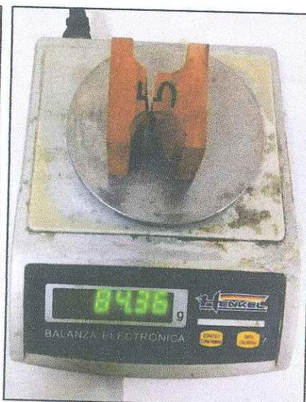
**FIGURA N°30:** Peso de la Probeta 5 después del secado en la estufa.
