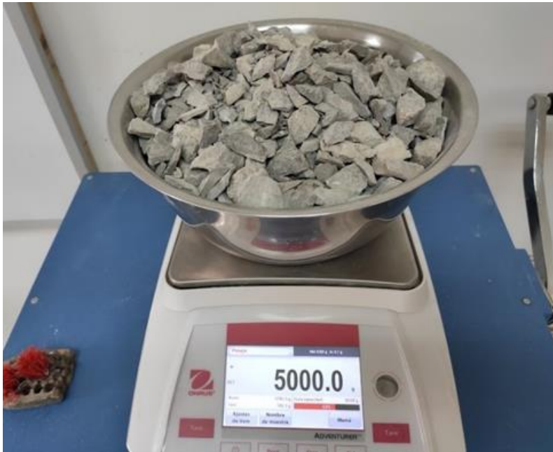
Foto N° 03: Pesado de agregado grueso de cantera para realizar el análisis granulométrico.
