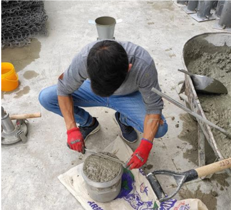
Foto N° 51: Ensayo de peso específico de concreto fresco.
