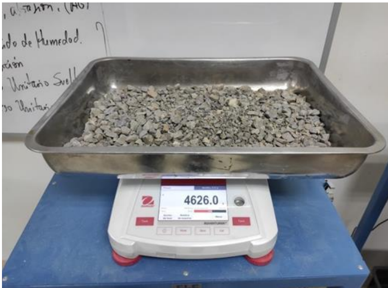
Foto N° 13: Pesado de muestra final después de secado en estufa para ensayo de abrasión.
