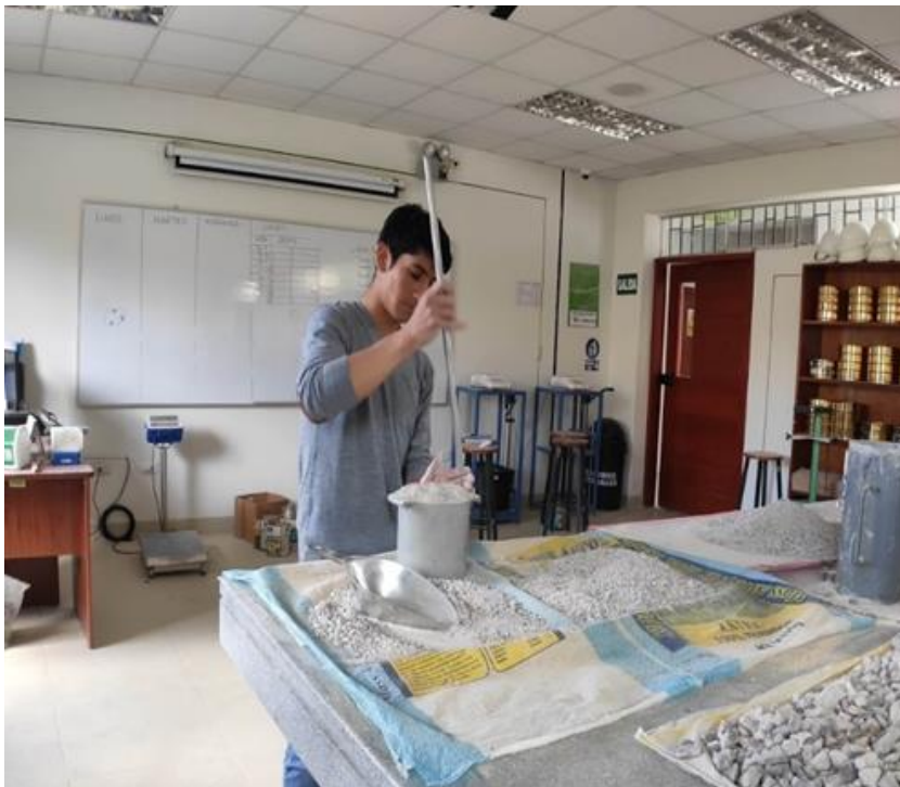
Foto N° 44: Ensayo de peso unitario variado del AF reciclado.
