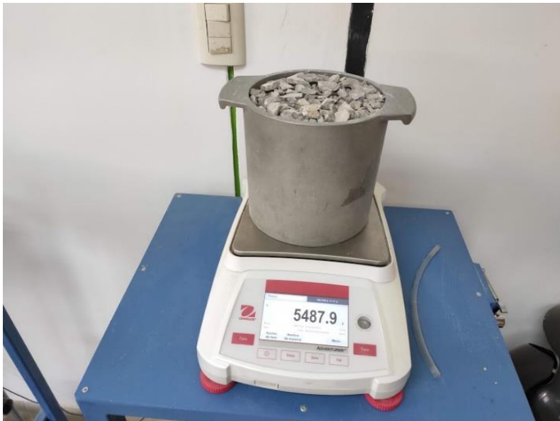
Foto N° 08: Pesado de olla más muestra de AG para ensayo de peso unitario suelto.
