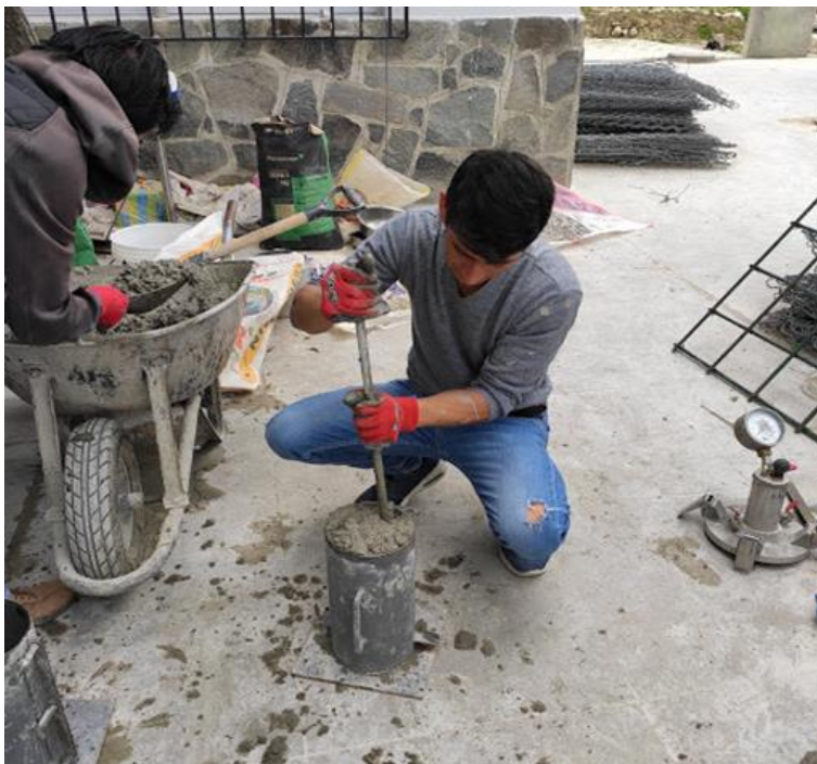
Foto N° 52: Varillado en el llenado de probetas.
