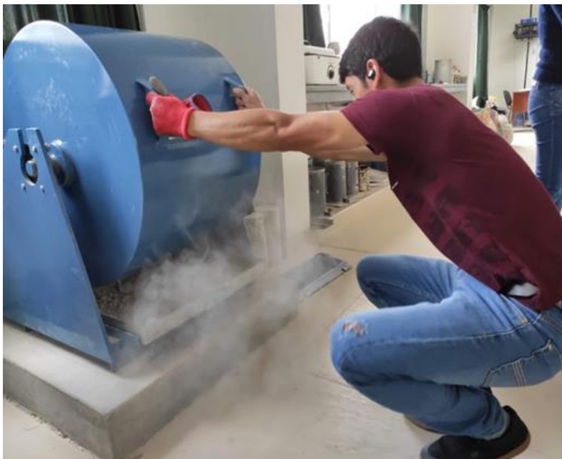
Foto N° 12: Retirado de muestra después de las 500 revoluciones para ensayo de abrasión en la máquina de los Ángeles.
