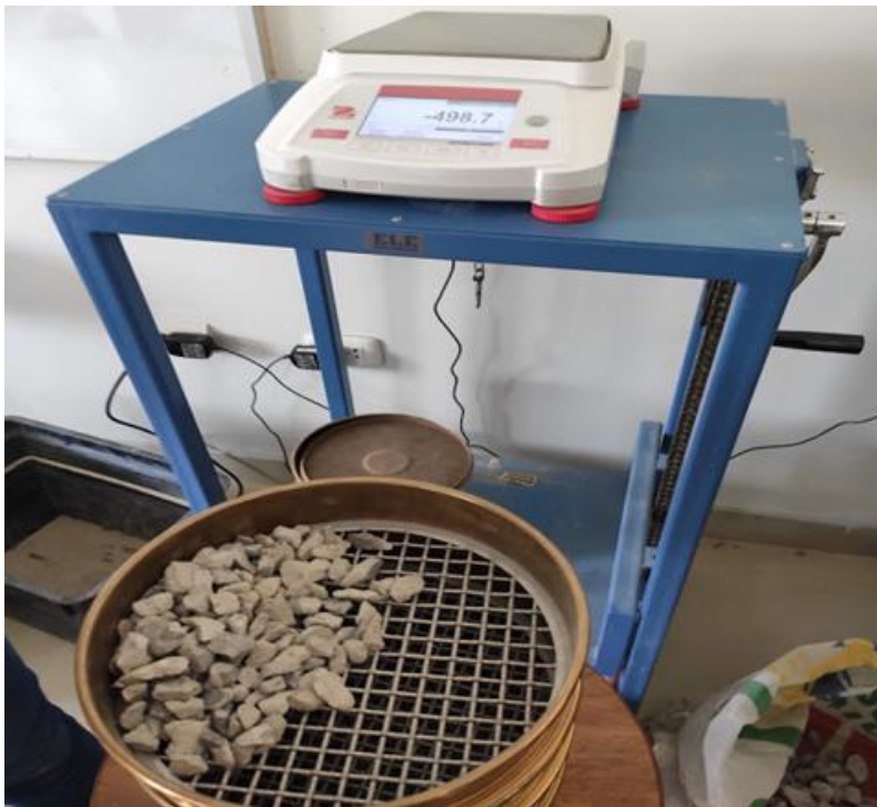
Foto N° 30: Pesos retenidos en tamices – análisis granulométrico.
