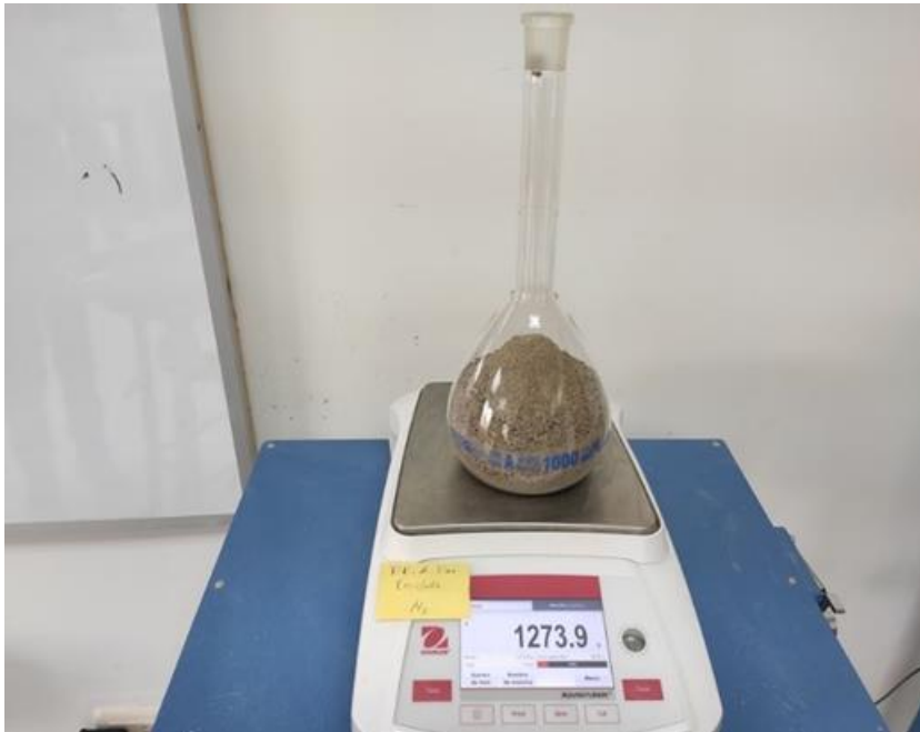
Foto N° 41: Peso de muestra más peso de la fiola del AF reciclado para ensayo de peso específico y absorción.
