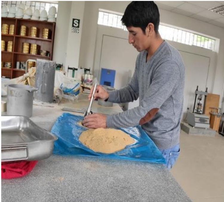
Foto N° 17: Realizando el ensayo superficial de humedad que es parte del procedimiento para encontrar el peso específico.
