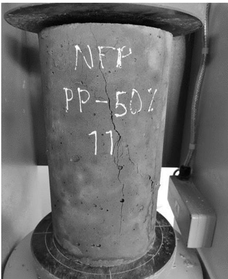
Foto N° 57: Ensayo de compresión axial con una falla del tipo 2.
