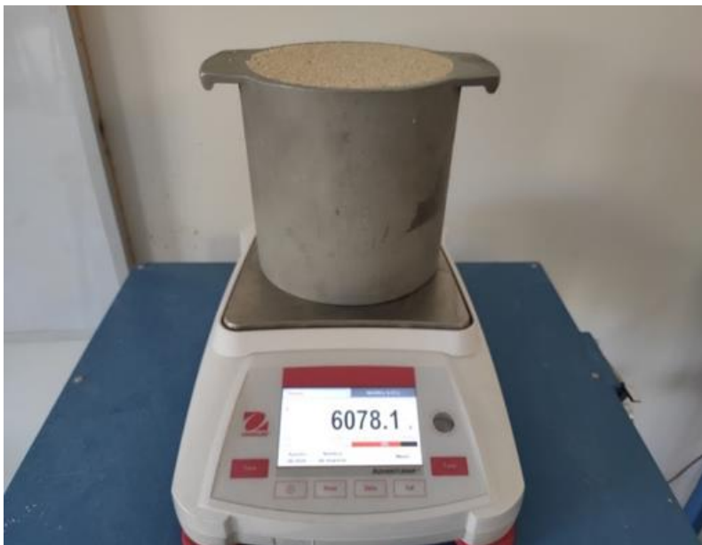
Foto N° 22: Pesado de muestra AF más olla para ensayo de peso unitario variado.
