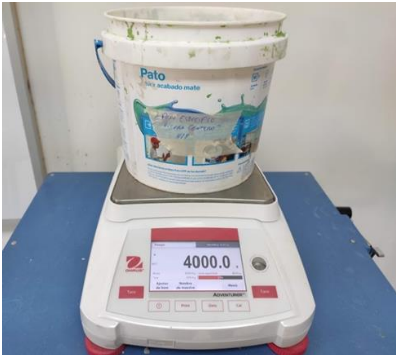
Foto N° 05: Pesado de muestra para ensayo de peso específico y absorción.
