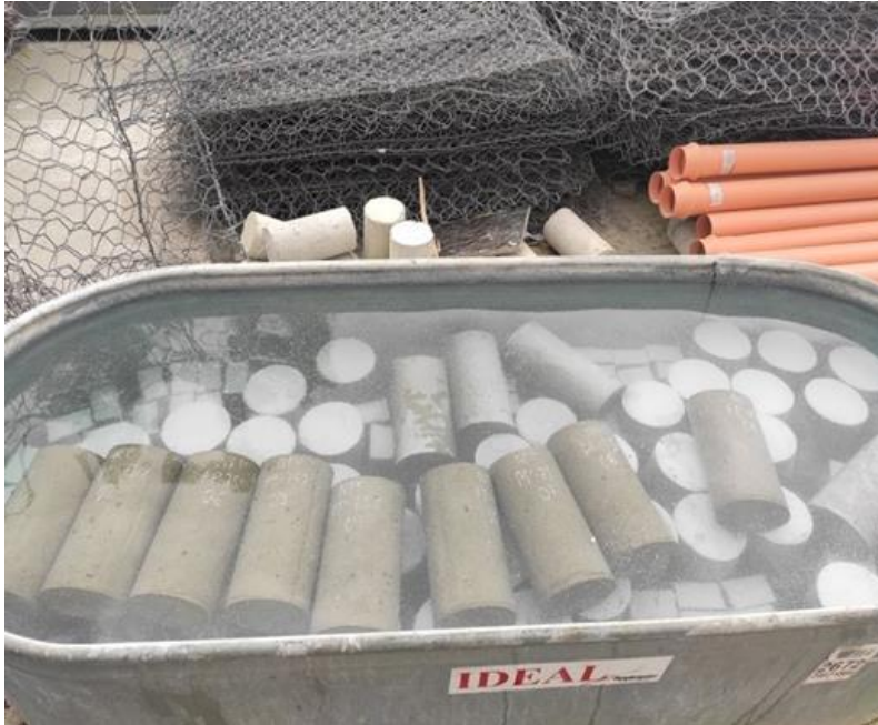
Foto N° 55: Curado de probetas hasta su ruptura.
