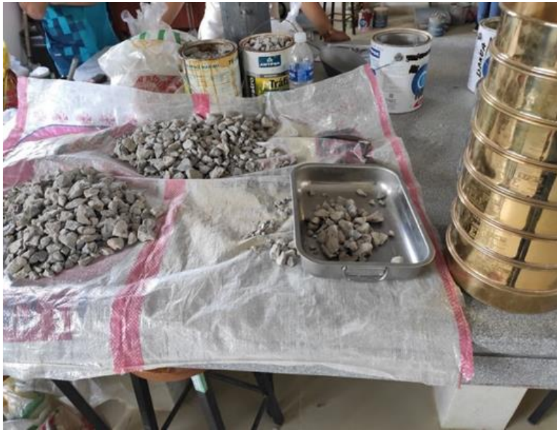
Foto N° 29: Gradación del agregado grueso reciclado
