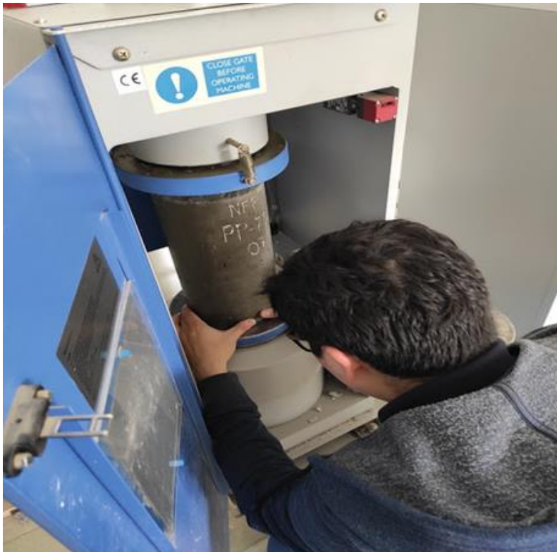
Foto N° 56: Colocación de probeta en máquina de compresión.
