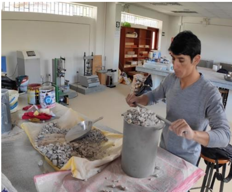
Foto N° 34: Ensayo de peso unitario suelto del AG reciclado.
