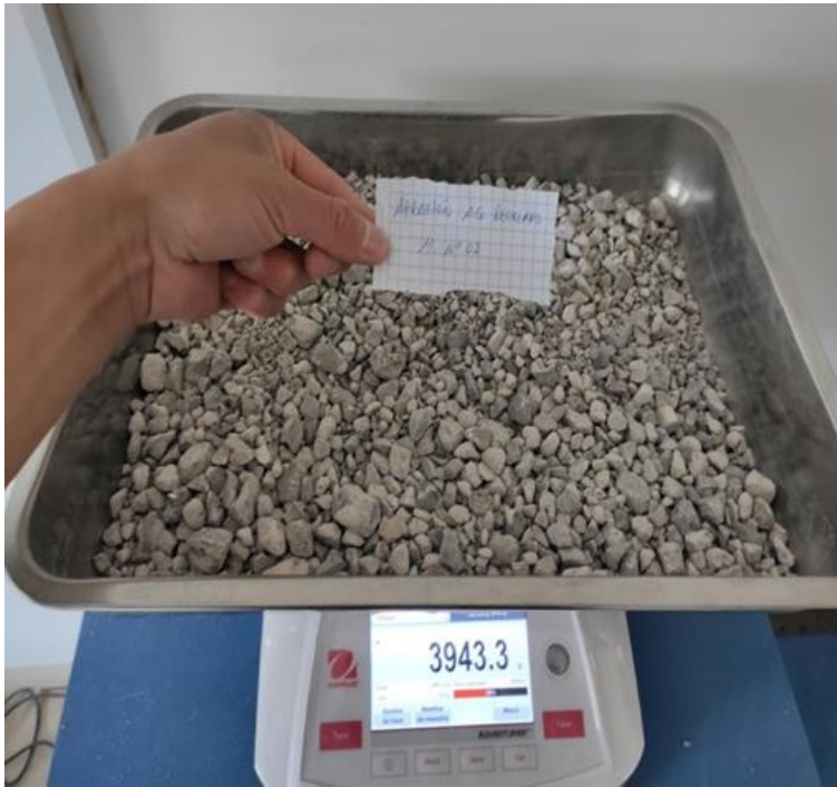
Foto N° 33: Muestra seca al horno después de pasar por la máquina de los ángeles - ensayo de abrasión.
