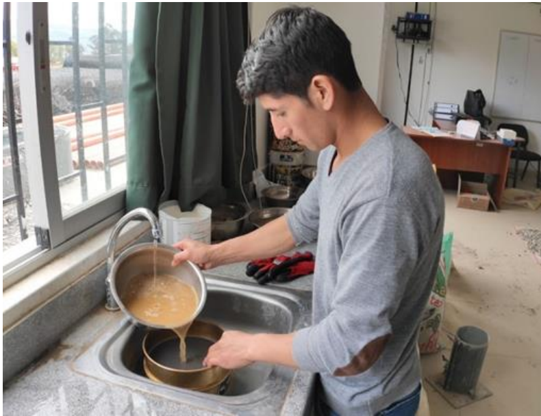
Foto N° 23: Lavado de AF en ensayo de porcentaje que pasa tamiz # 200.
