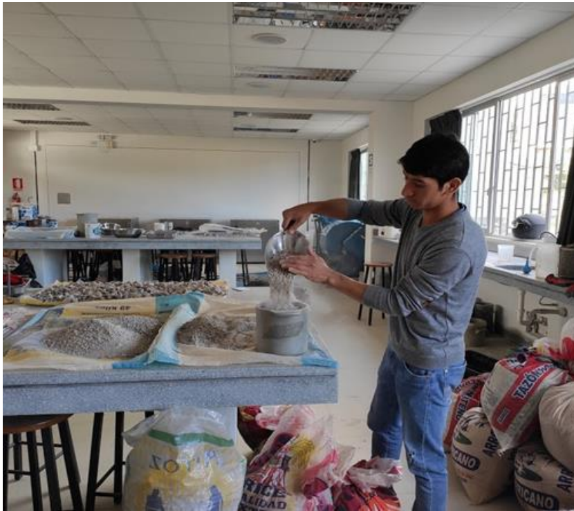
Foto N° 43: Ensayo de peso unitario suelto de agregado fino reciclado.
