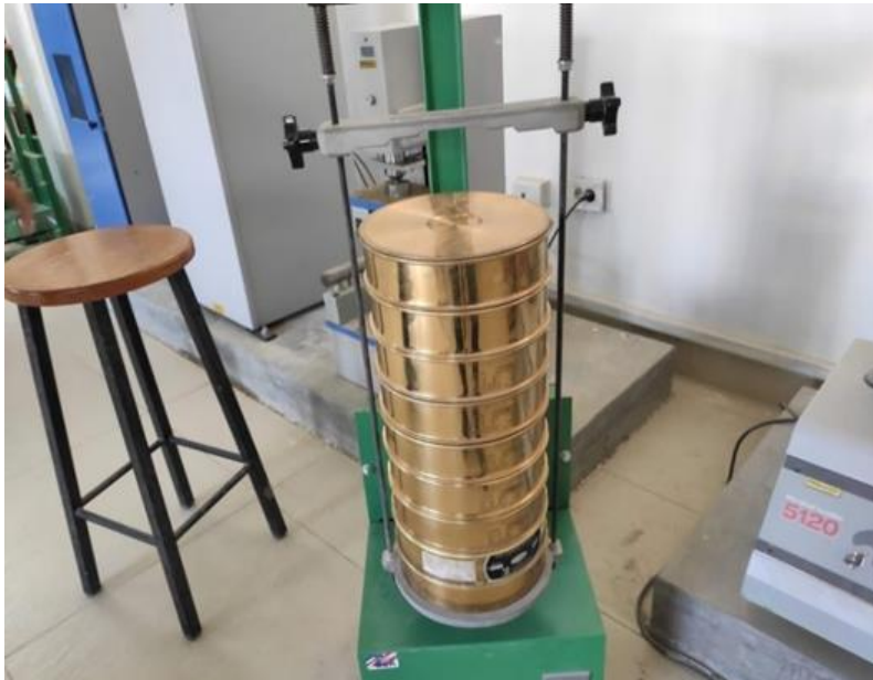
Foto N° 04: Proceso de Tamizado durante 5 minutos en el agitador mecánico.
