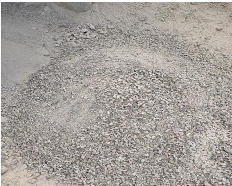
Foto N° 38: Material sobrante del tamizado de agregado grueso reciclado y que se tamizara para obtener agregado fino reciclado.
