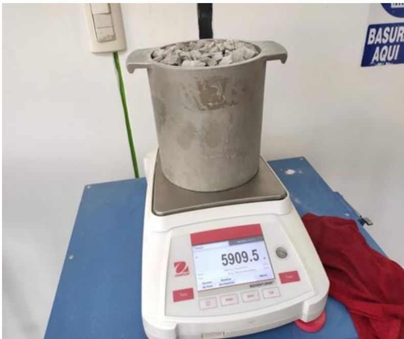
Foto N° 10: Pesado de olla más muestra de AG para ensayo de peso unitario variado.
