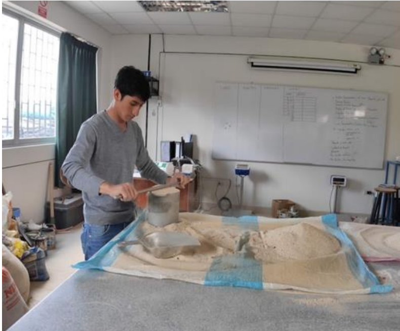
Foto N° 21: Llenado de olla para realizar ensayo de peso unitario variado del AF.
