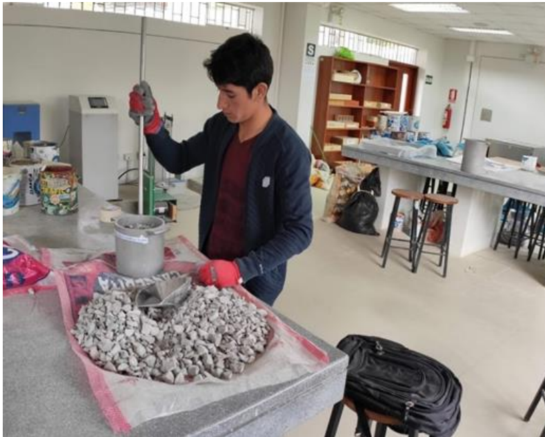
Foto N° 09: Llenado de olla con AG para ensayo de peso unitario variado.
