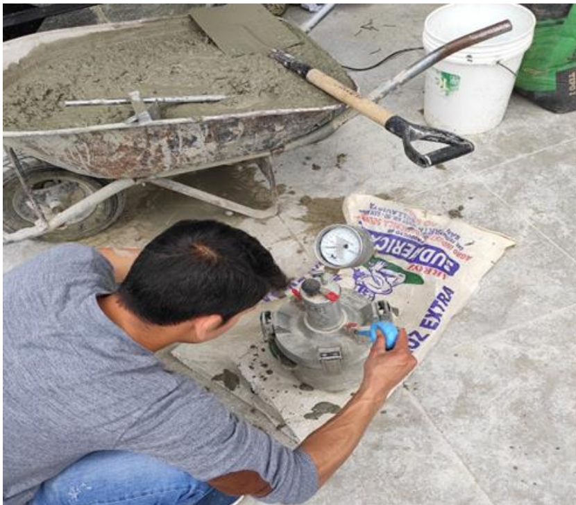
Foto N° 50: Ensayo de contenido de aire por el método de presión.
