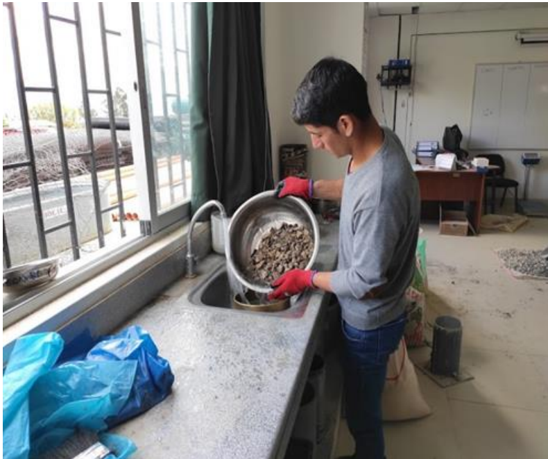
Foto N° 11: Lavado de agregado grueso para verificar el porcentaje de finos que pasan el tamiz # 200.
