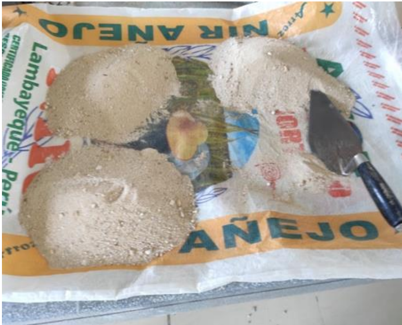
Foto N° 15: Cuarteo para inicio de análisis granulométrico de arena.
