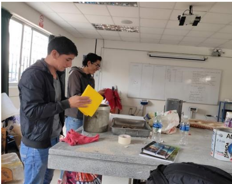
Foto N° 06: Secado superficial de la muestra para obtener la muestra saturada con superficie seca.
