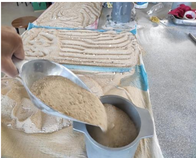
Foto N° 19: Llenado de olla para realizar ensayo de peso unitario suelto del AF.
