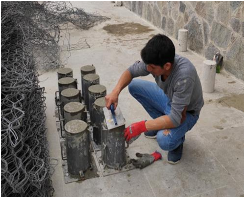
Foto N° 53: Acabado superior de probetas
