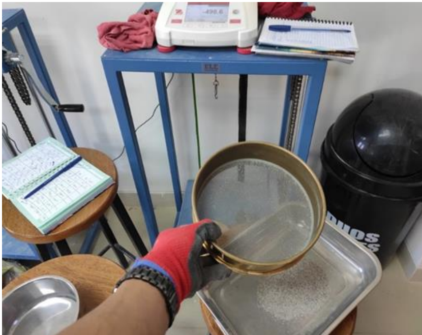
Foto N° 40: Pesos retenidos de agregado fino reciclado – Análisis granulométrico.
