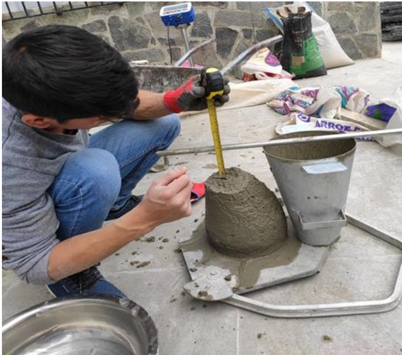
Foto N° 49: Ensayo de slump con el cono de Abrams.
