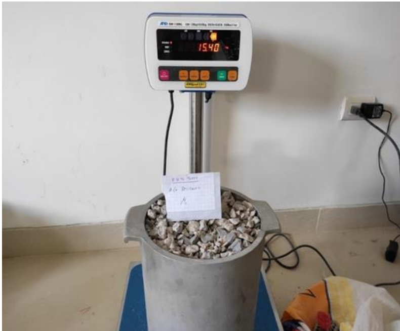
Foto N° 35: Peso de muestra en olla - Ensayo de peso unitario suelto.
