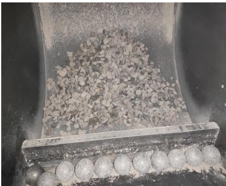
Foto N° 32: Muestra en la máquina de los ángeles para ensayo de abrasión del AG reciclado.
