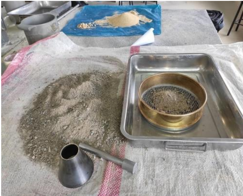
Foto N° 39: Agregado fino reciclado después de pasar por el tamiz de 3/8".
