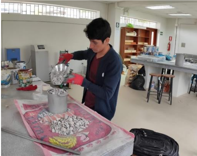
Foto N° 07: Llenado de olla con AG para ensayo de peso unitario suelto.
