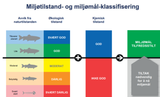
Figur 8. Tilstand settes iht. avvik fra antatt naturtilstand. God eller svært god økologisk tilstand samt god kjemisk tilstand i en vannforekomst tilsier oppnådd miljømål. Direktoratsgruppen vanddirektivet (2018). Veileder 02:2018 Klassifisering av miljøtilstand i vann, s.7. Tilgjengelig fra: https://www.vannportalen.no/veiledere/klassifiseringsveiled er/ (lest 14.03.2022)
