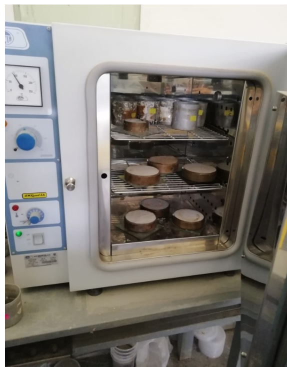
Imagen 88: Secar en la estufa la muestra.
