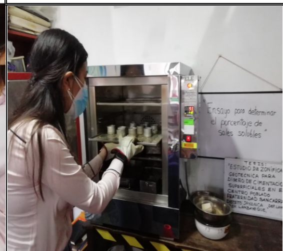
FOTO N°64: Secado en la estufa, para que evapore agua y quede solo sal.
