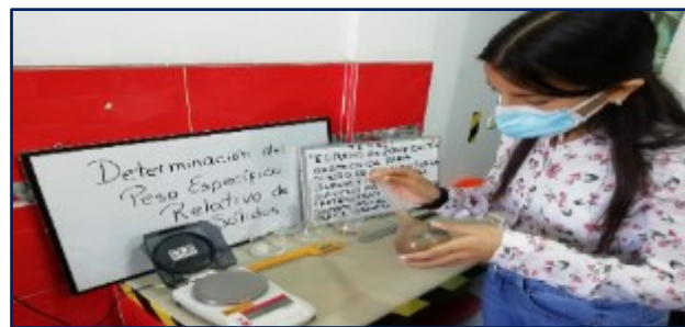
Imagen 53: Agitamos para desalojar el aire atrapado en la muestra.
