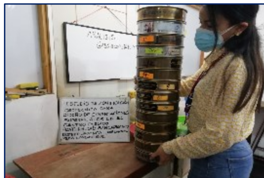
Imagen 29: Zarandeo de muestra secada.
