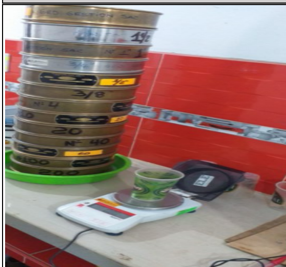
FOTO N°36: Peso de muestras para análisis granulométrico por tamizado.
