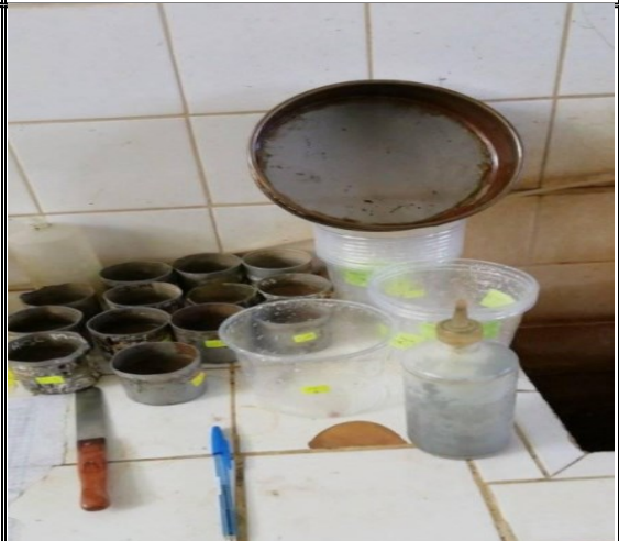
FOTO N°22:Lavado de muestras para Análisis Granulométrico por Tamizado
