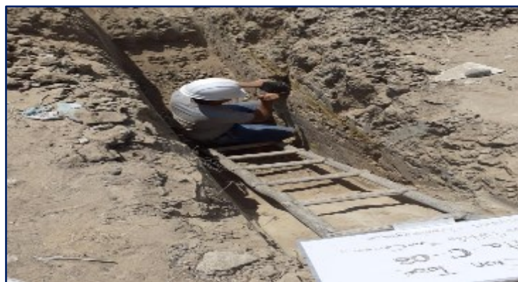
Imagen 17: Tallado de molde para muestras inalteradas
