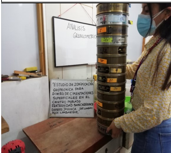
FOTO N°38: Tamizado de muestras en mallas.
