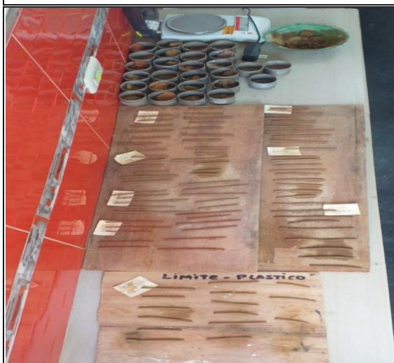
FOTO N°31: Cilindro del suelo D= 3.18 mm y L= 7.5 cm aprox.
