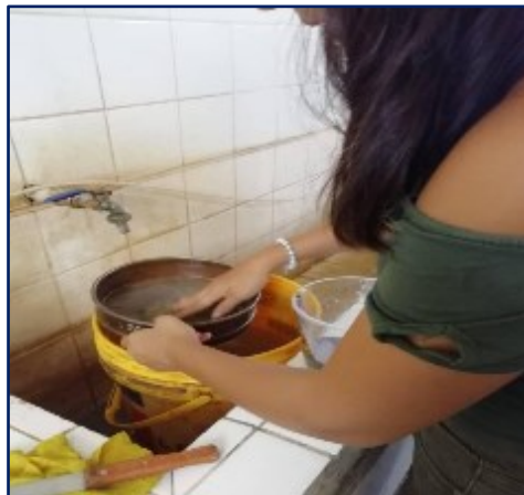
Imagen 27: Lavado de las muestras con el tamiz N°200
