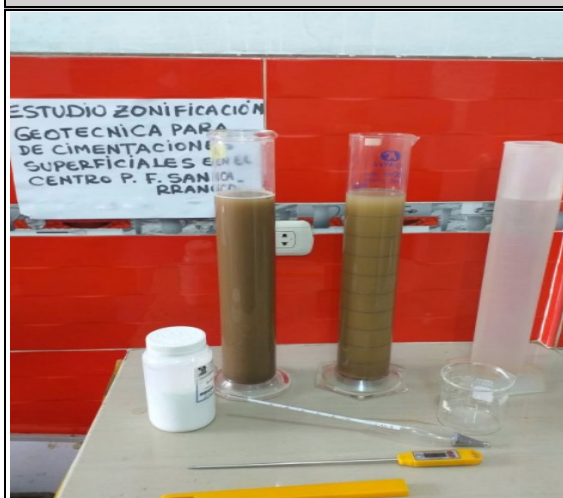
FOTO N°41: Instrumentos para Análisis granulométrico por sedimentación.
