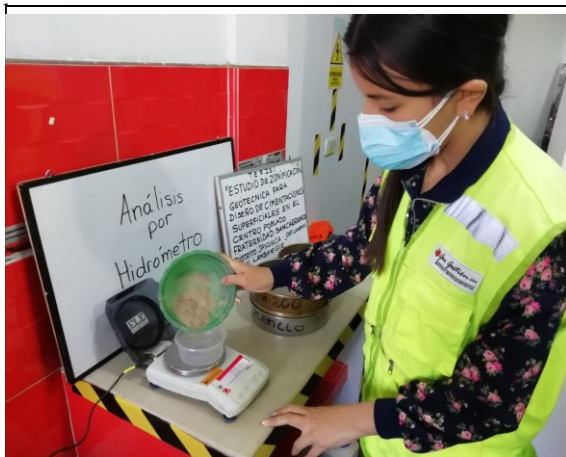
FOTO N°43: Peso de muestra, La cantidad requerida para suelos arenosos es de 75 a 100 gr y para limos y arcillas de 50 a 60 g
