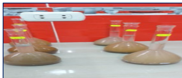
Imagen 54: Fiola más suelo seco y agua destilada en suspensión.
