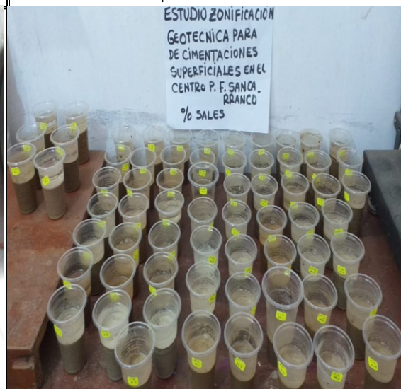
FOTO N°66: Saturación de muestras.
