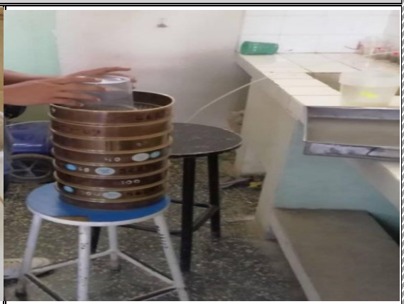
FOTO N°24: Tamizado de muestras después del secado en el horno .
