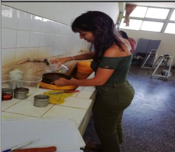
FOTO N°21:Lavado de muestras para Análisis Granulométrico por Tamizado en LMS-UNPRG
