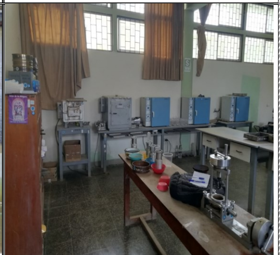
FOTO N°28: Secado de muestras en estufa
