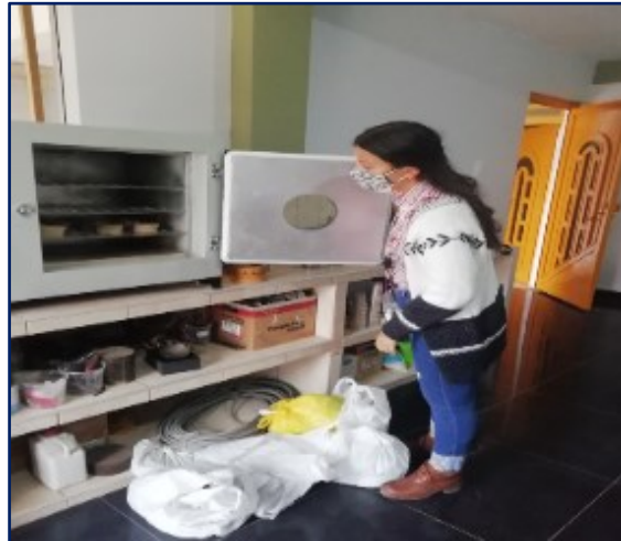
Imagen 73: Muestras en la estufa por 24 horas.
