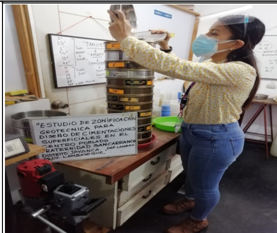
FOTO N°38: Tamizado de muestras en mallas.
