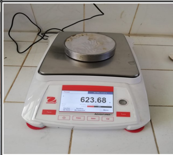
FOTO N°82: Peso de muestra con anillo.
