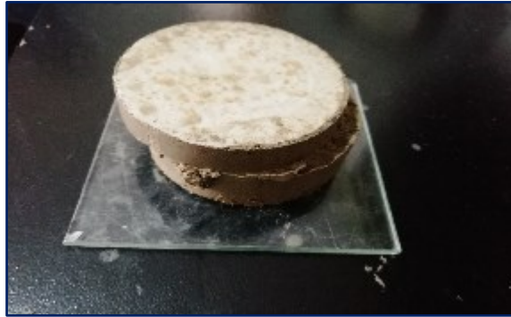
Imagen 71: Muestra con falla por cortante.
