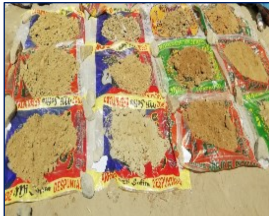
Imagen 25: Secado de muestras al sol.
