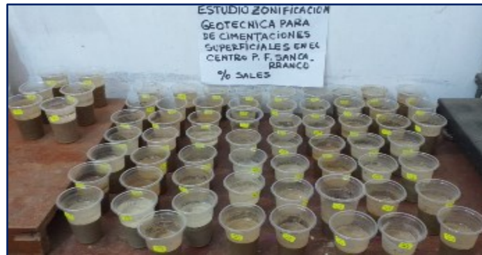
Imagen 58: Saturar muestras de suelo con agua destilada por 24 h.
