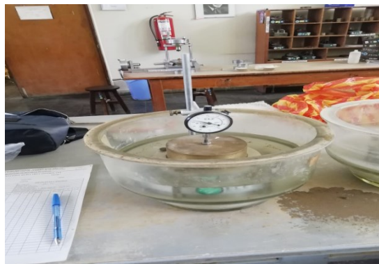
FOTO N°79: Montaje de muestra con aparato de expansión bajo carga controlada.
