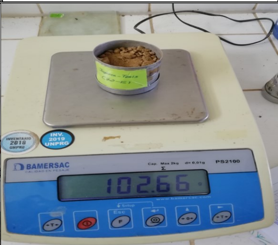
FOTO N°20:Peso de muestras para Contenido de Humedad
