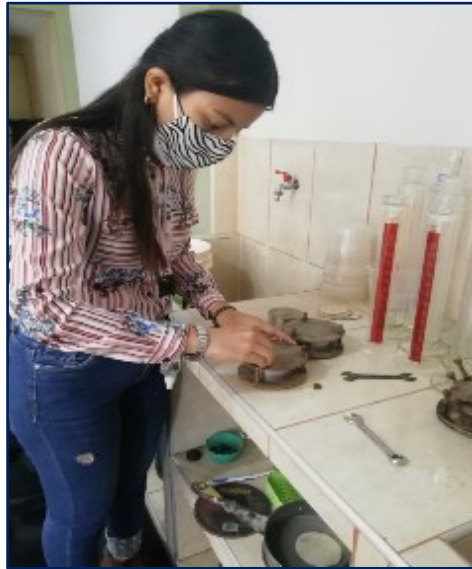
Imagen 67: Anillos colocados en bloqueadores.
