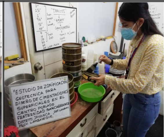
FOTO N°39: Obtener pesos parciales por tamices.
