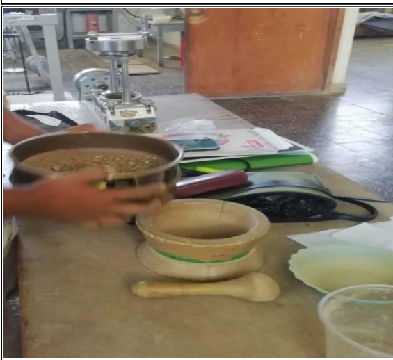
FOTO N°27: Tamizado para límite líquido.
