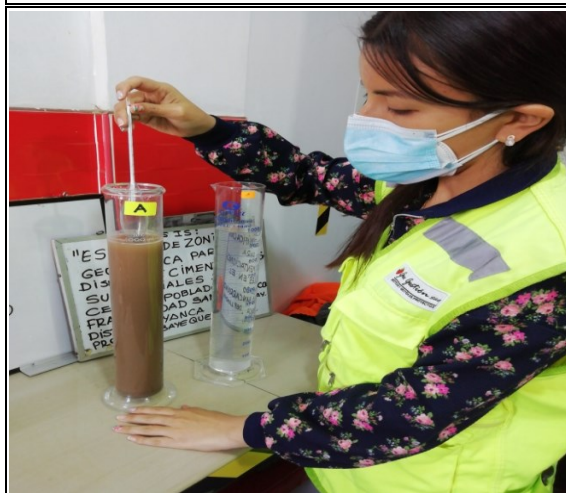
FOTO N°47: Colocar el hidrómetro y tomar lecturas.
