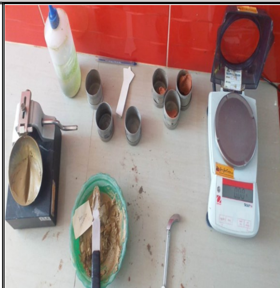
FOTO N°30: Masa húmeda en la parte central de la copa de casagrande.
