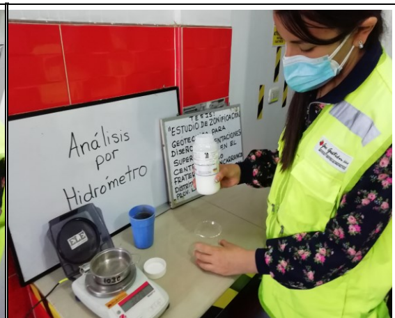
FOTO N°44: Preparar la solución agua destilada 125 ml y pesar 5.0 gr de floculante y mezclar ambos en un frasco volumétrico.
