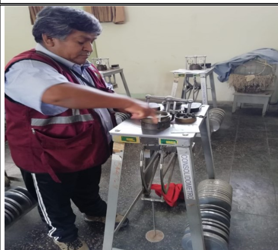
FOTO N°71: Desmonta muestra con anillo del consolidómetro.
