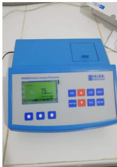
Imagen 82: Lectura de iones sulfatos.
