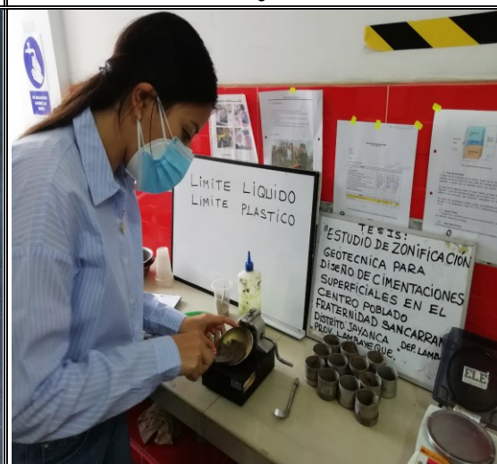
FOTO N°30: Masa húmeda en la parte central de la copa de casagrande.
