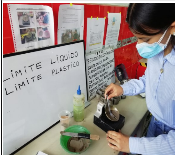
FOTO N°33: Paso del acanalador por el centro de la copa.
