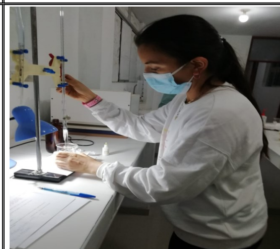
FOTO N°88: Titulación con nitrato de plata.
