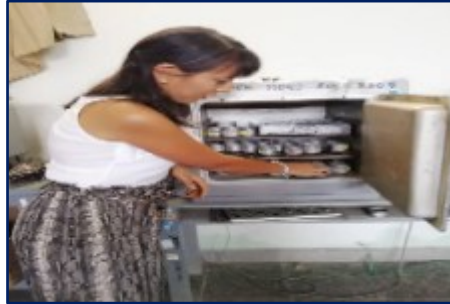
Imagen 21: Cápsulas con muestras llevadas a la estufa.
