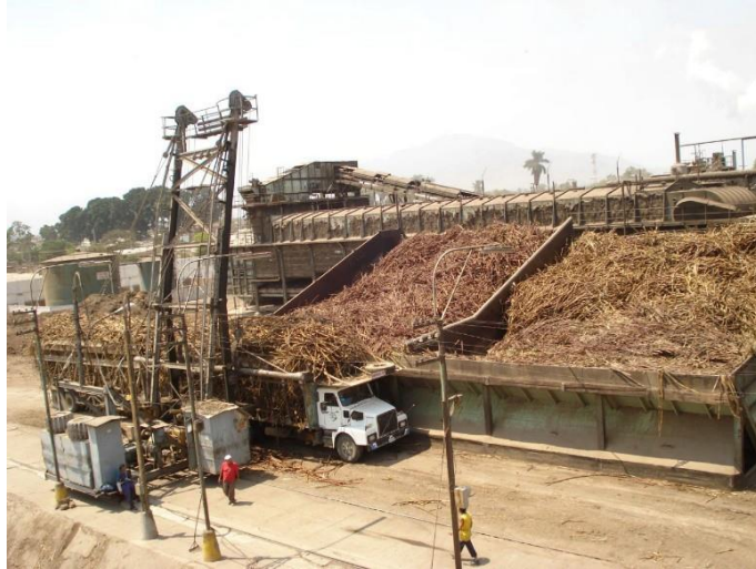
Figura N° 3. Descarga de la caña, usando grúas
