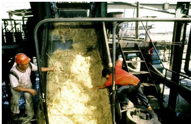
Figura N° 5. Conductores de bagazo
