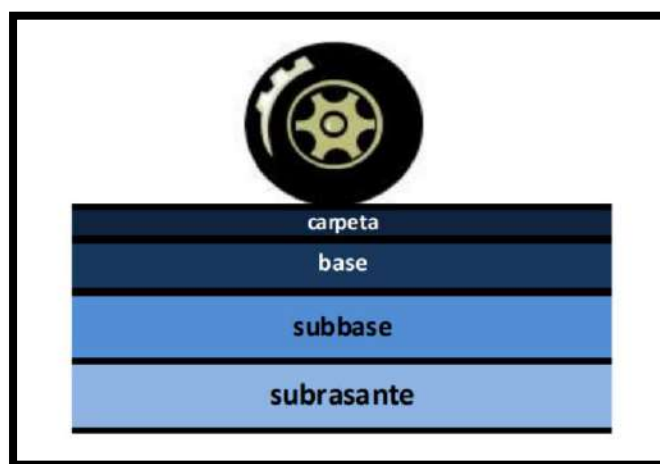
Figura 2. Esquema típico del paquete estructural de un pavimento flexible.
