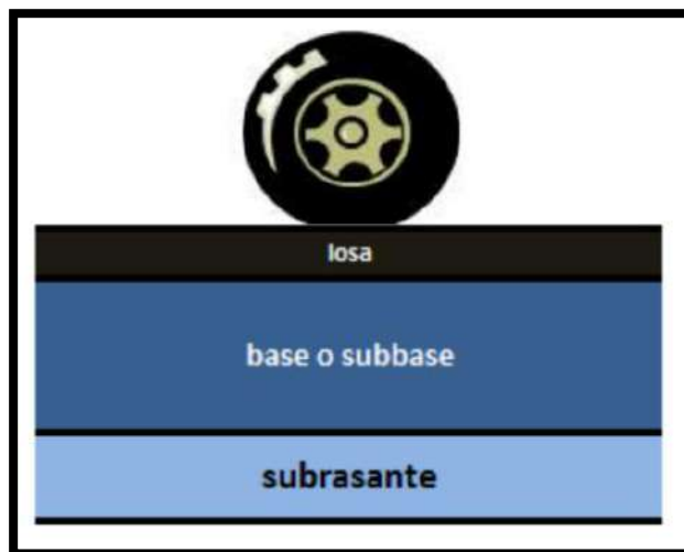
Figura 4. Esquema típico del paquete estructural de un pavimento rígido.
