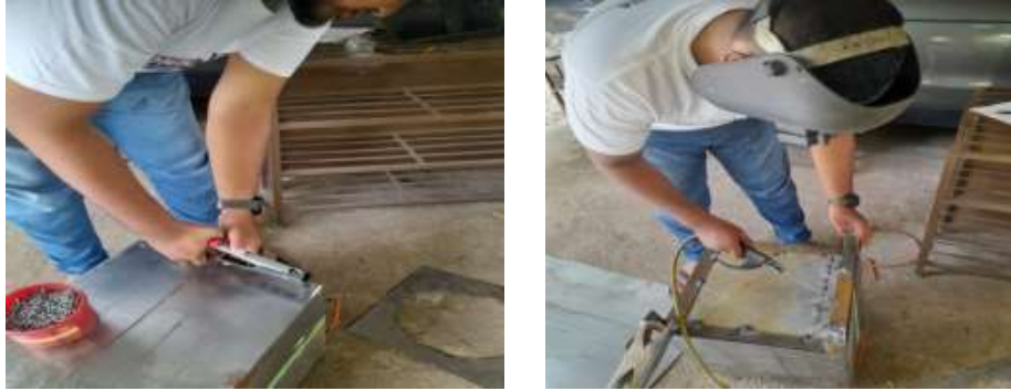
Gambar 8. Pemasangan rivet dan Pengelasan bagian bawah kompor
