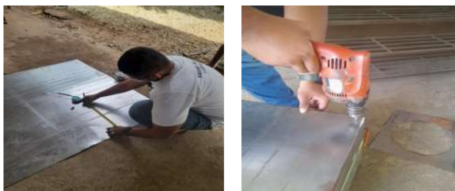
Gambar 7. Pelubangan Tabung Bagian Dalam dan Pelubangan Dinding Rangka Dengan Mesin Bor
