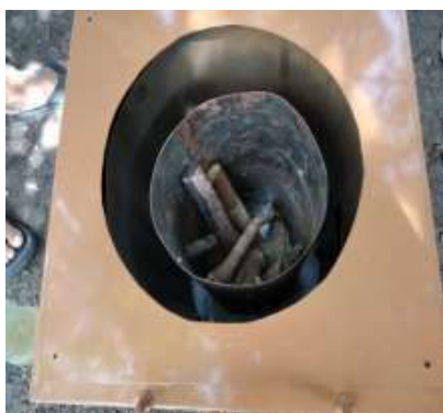
Gambar 11. pengujian dengan 1 kg kayu karet dan Api kompor biomassa
