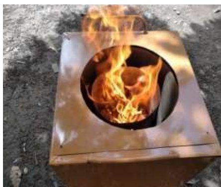
Gambar 11. pengujian dengan 1 kg kayu karet dan Api kompor biomassa
