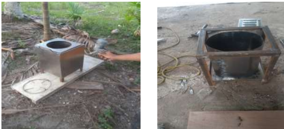
Gambar 10. Proses Pengcatan Kompor dan Proses Pengamplasan Bagian Dalam
