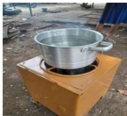
Gambar 12. Pengujian 1kg kayu karet dengan 5 Liter Air
