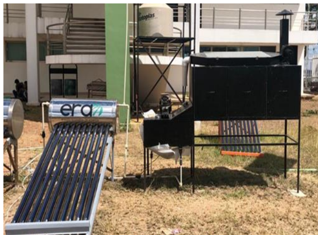
Fig. 2. Secador solar tipo túnel con hibridación de tecnologías solares en operación.
